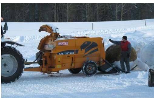
KUVIO 10. Hydraulisella peräportilla varustettu paalisilppuri (kuva: Markku Lätti)
