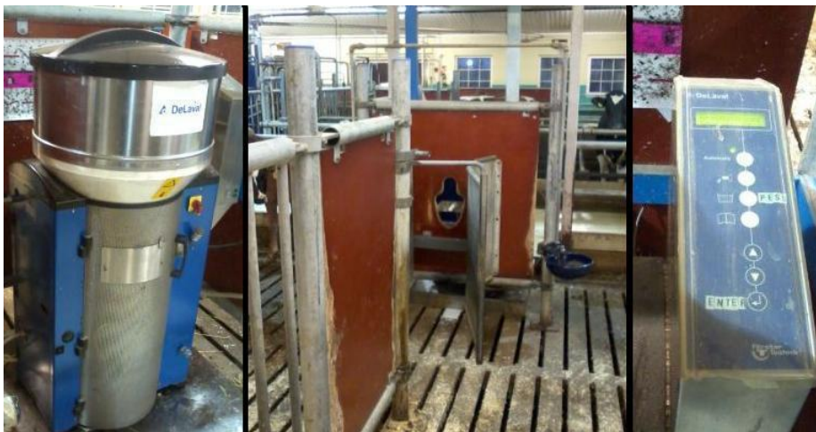
KUVIO 20. Vasikoiden juottoautomaatti kuvattuna karsinan ulko- ja sisäpuolelta, ja automaatin hallintaliittymä (kuva: Miika Hartikainen)
