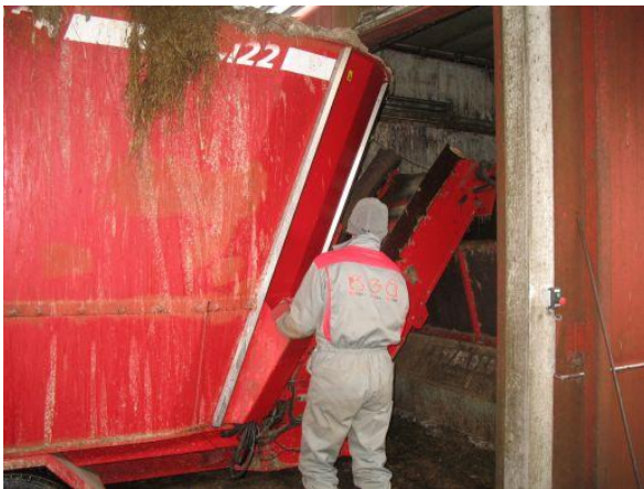
KUVIO 23. Seosrehuvaunun peräosaan asennettu purkumatto (kuva: Markku Lähti)
