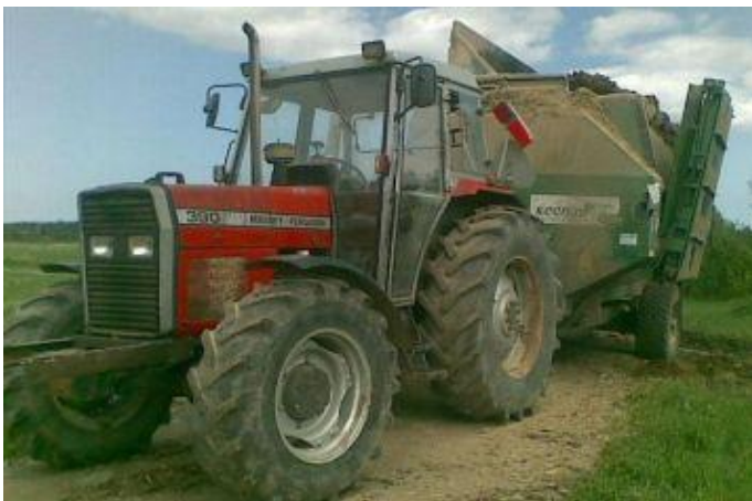
KUVIO 17. Vetotraktori ja siihen kytketty 17 m 3 :n seosrehuvaunu (kuva: Miika Hartikainen)
