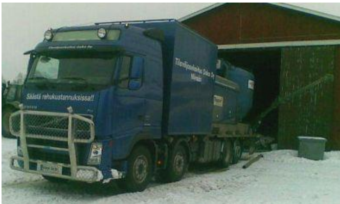
KUVIO 11. Kuorma-autoalustainen väkirehun jauhatus- ja sekoituslaitteisto (kuva: Miika Hartikainen)
