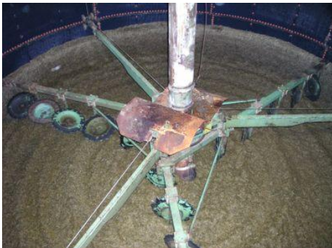
KUVIO 6. Tornisiilon sisällä oleva täyttöpurkain (kuva: Markku Lätti)
