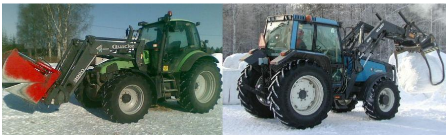
KUVIO 2. Maataloustraktorit etukuormaimen rehuleikkurilla ja paalipihdillä varustettuna (kuvat: Miika Hartikainen & Markku Lätti)
