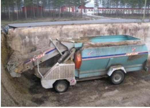
KUVIO 19. Ajettava seosrehuvaunu täyttöjyrsimellä varustettuna (kuva: Markku Lähti)
