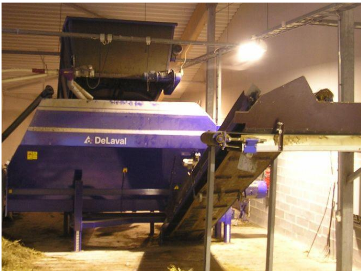
KUVIO 25. Kiinteä rehusekoitin varustettuna täyttöpöydällä ja yhdistettynä matto-ruokkimeen (kuva: Markku Lätti)
