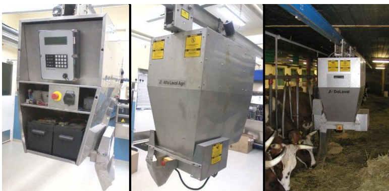
KUVIO 16. Väkirehusukkula, jonka akut ovat sijoitettuna laitteen pohjalle päätyosaan, ja väkirehusukkula jakokierroksellaan (kuvat: Miika Hartikainen & Markku Lätti)
