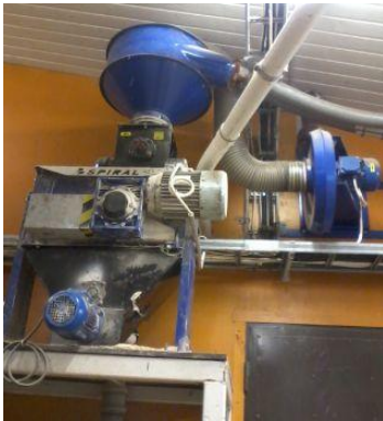
KUVIO 13. Imulietsoilla ja spiraalipurulla varustettu valssimylly (kuva: Miika Hartikainen)
