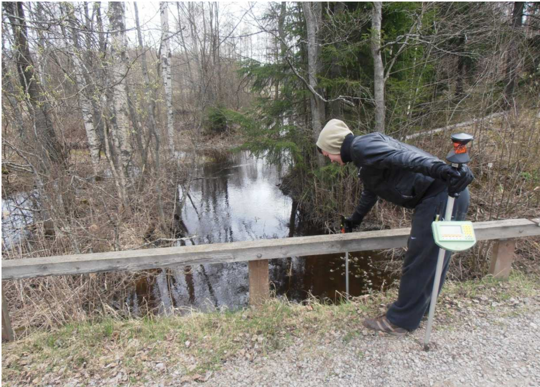
Kuva 6. Ojan pohjan mittaus.
