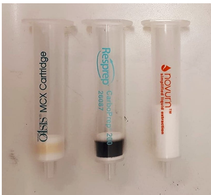
Kuva 8. Uuttopatruunat vasemmalta oikealle; 1.Oasis MCX 6 cc 150 mg; 2. Resprep SPE Carboprep 200, 500 mg 6 ml; 3. Novum SLE 6 cc.
