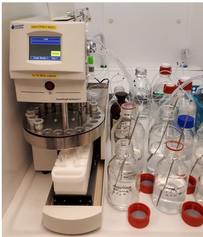
Kuva 9. Automaattinen kiinteäfaasiuuttolaitteisto. Valkoisessa telineessä vastaanottoputket, pyöreässä telineessä uuttopatruunat (kolonnit), oikealla näytepulloja.
