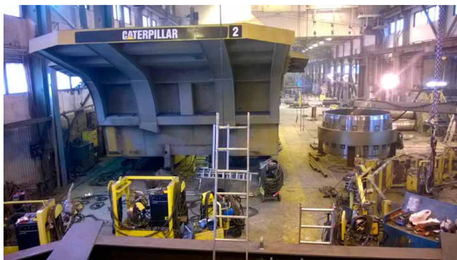
Kuva 8. Kaivoksen kiviauton lava kunnostettavana v. 2017.
