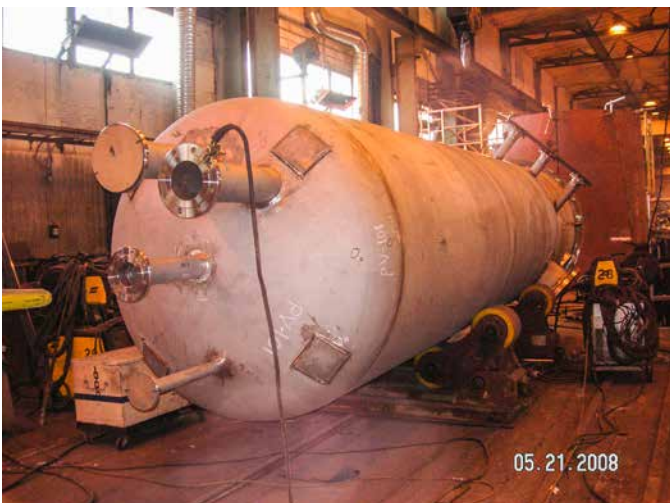
Kuva 5. Ruostumattomasta teräksestä tehty painesäiliö varusteltavana.
