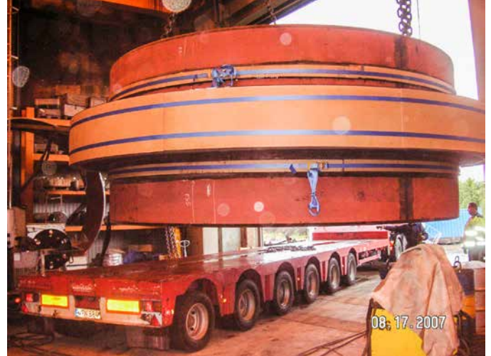
Kuva 4. 50 tonnin kuorimarummun kantolohkoa valmistellaan kuljetukseen.
