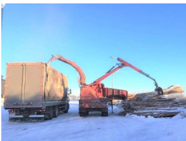
Fig. 4. Chipping of freshly-felled energy wood near the Kauhava district heating plant 4 pav. Skiedrų gamyba iš šviežiai nukirsto biokuro netoli Kauhava rajoninės katilinės
