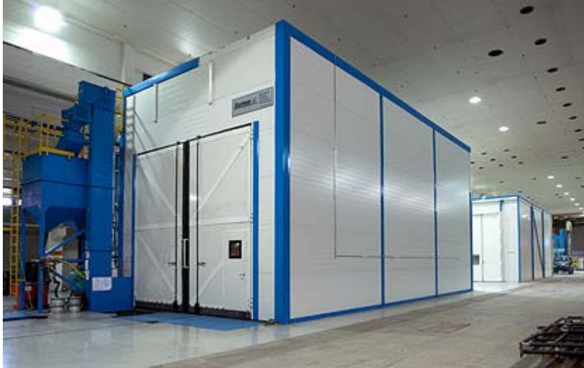
Kuvio 3. Raepuhallusrobotin kammio ulkopuolelta (Blastman Robotics Oy 2012.)
