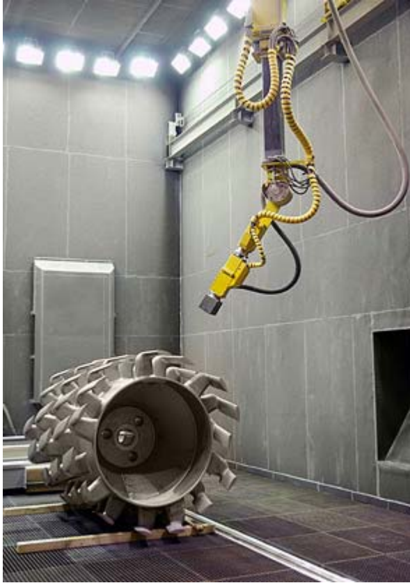
Kuvio 2. Työstettävä kappale ja raepuhallusrobotti kammiossa (Blastman Robotics Oy 2012.)
