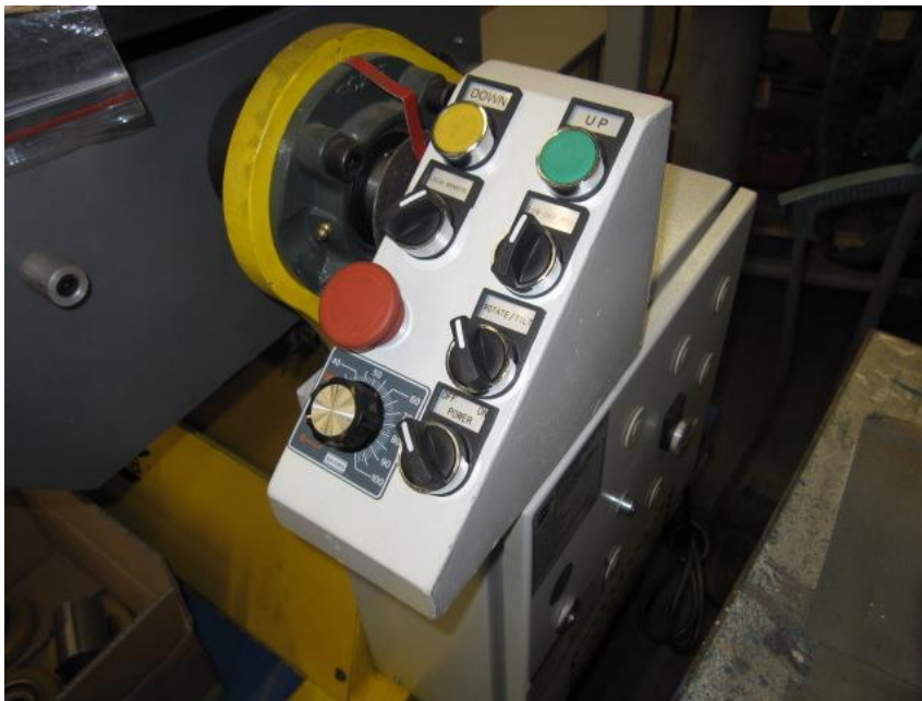
KUVA 20. Säätöviput muutettuna, varta vasten tehtyyn kehikkoon
