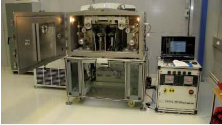
KUVA 13. EVA R2R-evaporator (17, s. 73)
