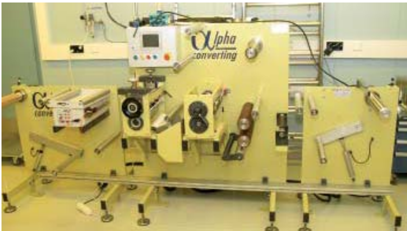
KUVA 14. R2R post treatment unit (17, s.73)
