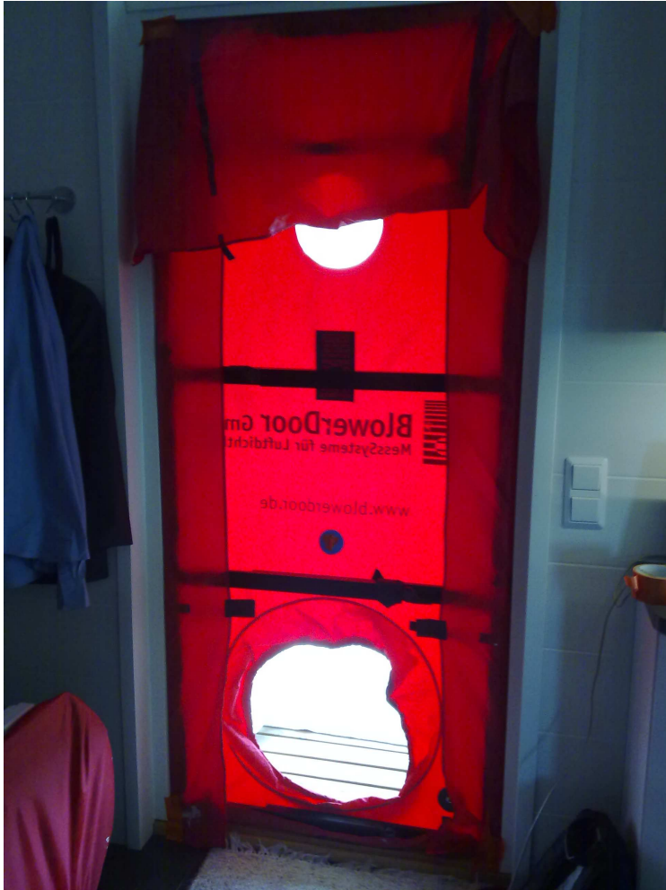
KUVA 9. Puhaltimen kehikko asennettuna ulko-oven karmeihin
