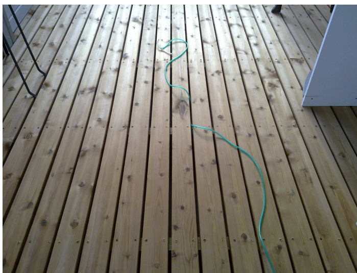
KUVA 8. Ulos laitettu paineenmittausletku
