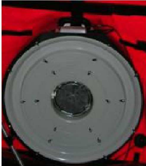
KUVA 11. Alipaineistettaessa sulkurenkaat talon sisälle päin
