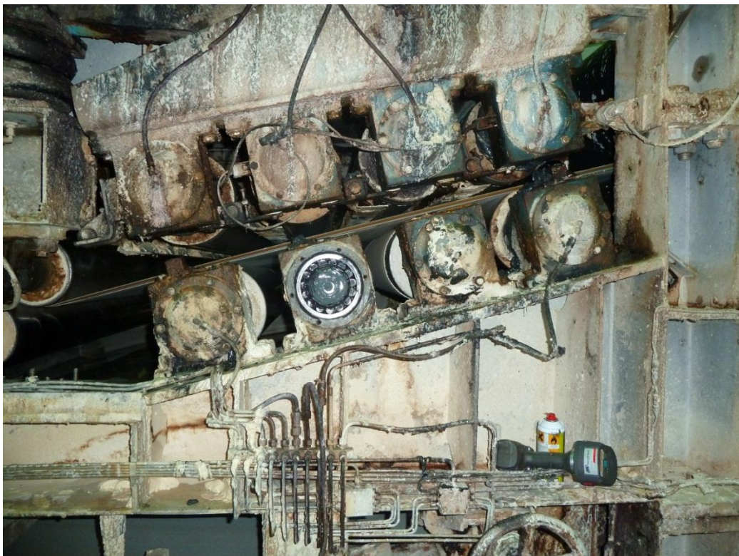
Kuva 3.4 Valkaispuristimen puristinosan telat (8kpl)
