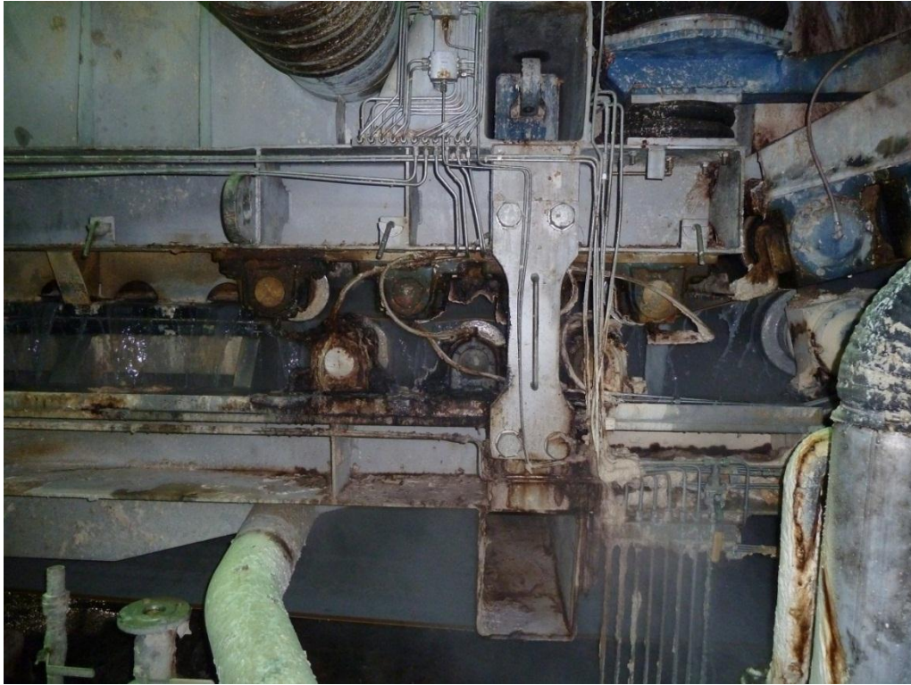
Kuva 3.3 Valkaispuristimen S-telat (7kpl)
