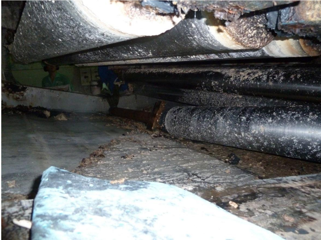
Kuva 6.13 Toinen puoli jouduttu laskemaan valkaisupuristimen pohjalle
