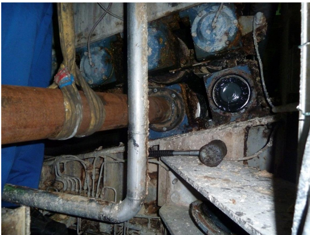
Kuva 6.4 Nostoapuväline kiinnitettyä laakerinpesän kannen reikiin
