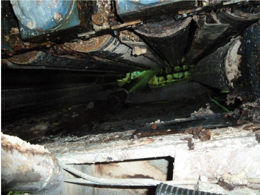
Kuva 6.6 Toinen nostoliina irroitettuna valkaisuupuristimen pohjalla.
