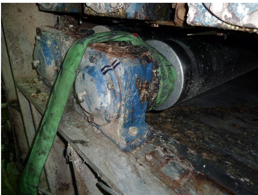
Kuva 6.4 Nostoapuväline kiinnitettyä laakerinpesän kannen reikiin
