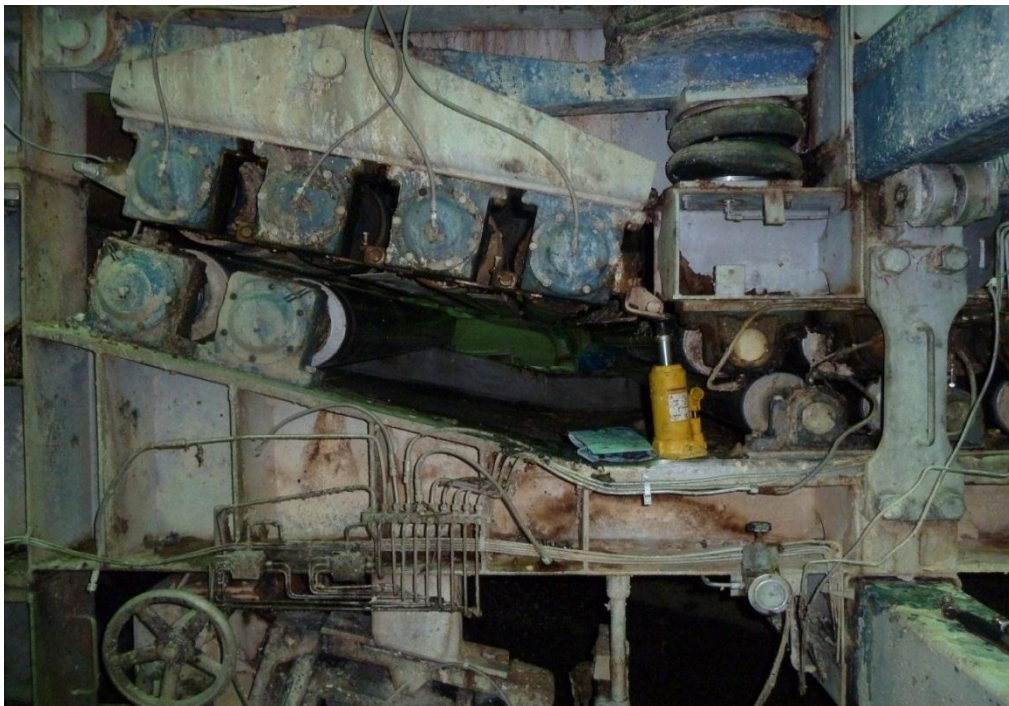
Kuva 6.1 Puristinosan alapuolen telojen vaihtaminen
