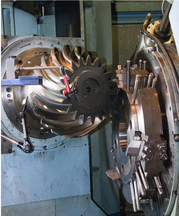
Kuva 3. Pinionin HPG-viimeistely (Ata Gears 2012)
