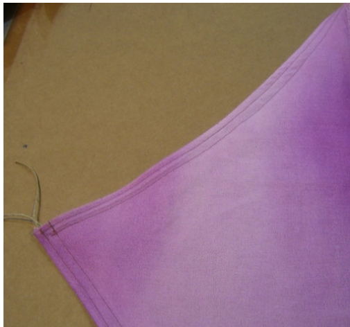
KUVA 27. Huolittelukokeilu 1 maalatulle kankaalle reunojen huolittelu muotokaitaleen avulla
