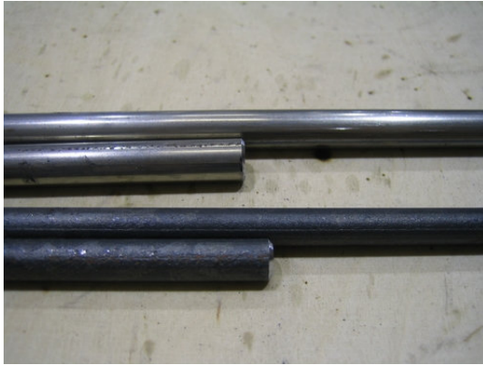
KUVA 8. Ylhäällä ohut seinämäinen huonekaluputki ja alhaalla umpitanko
