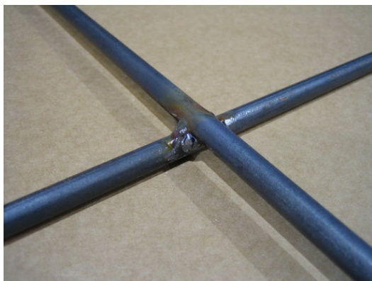
KUVA 14. Umpitanko valmis liitos.
