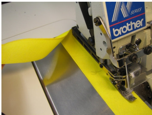
KUVAT 29. Ompelin leijojen huolittelukaitaleet päärmäyskoneella
