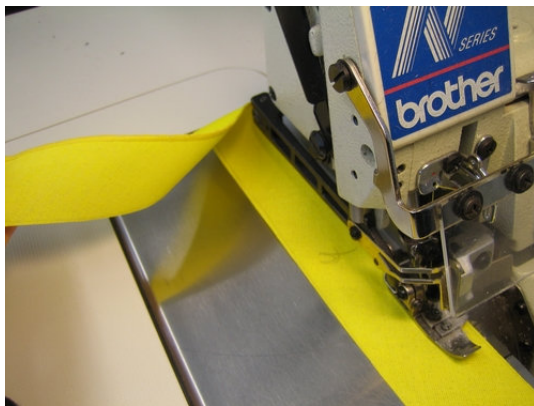
KUVAT 29. Ompelin leijojen huolittelukaitaleet päärmäyskoneella
