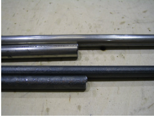
KUVA 8. Ylhäällä ohut seinämäinen huonekaluputki ja alhaalla umpitanko
