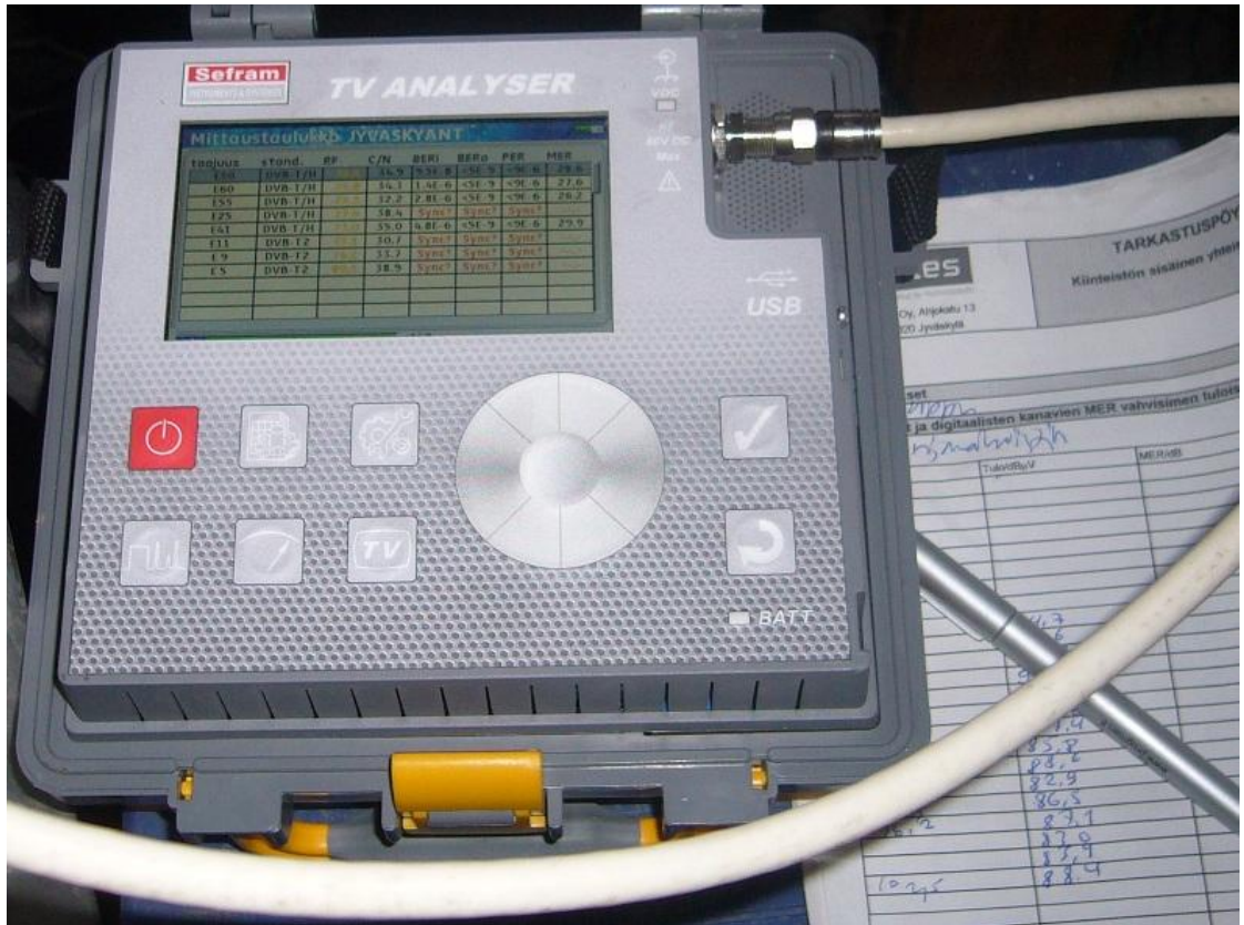
KUVA 17. Lähtötason mittaus vahvistimelta. (Valokuva Juho Pirttinen 2012)
