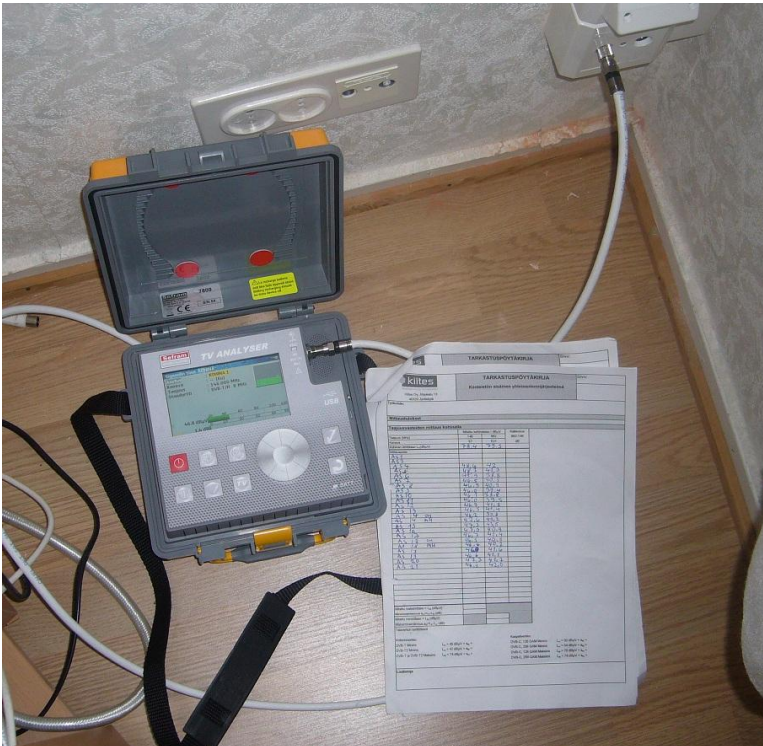
KUVA 14. Kohinan tason mittaus antennipistorasiasta. (Valokuva Juho Pirttinen 2012)
