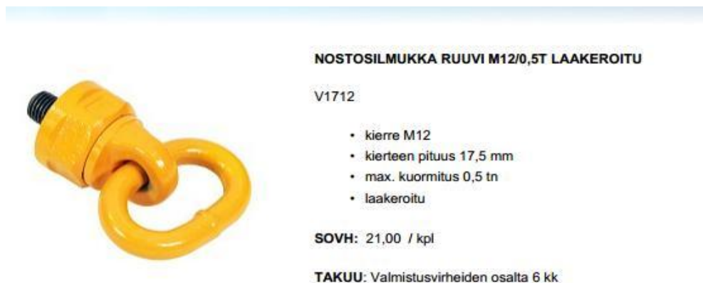
Kuva 6 Laakeroitu nostosilmukka M12 (IKH 2012.)
