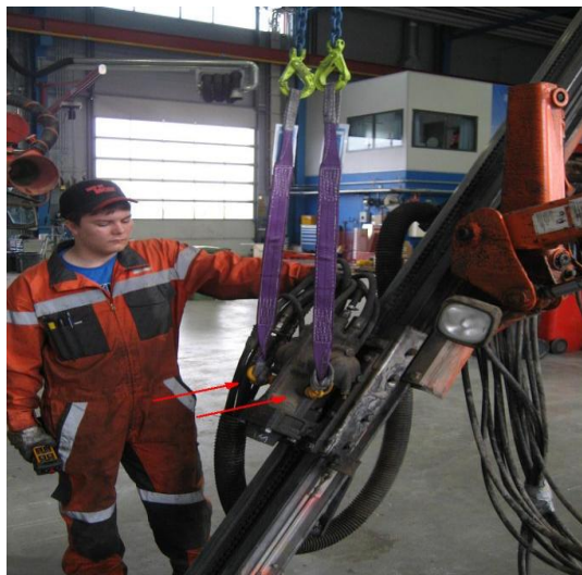
Kuva 7 HEX1 vasaran nosto laakeroitulla nostosilmukalla (Kuvaaja Teemu Mäkeläinen 2012.)
