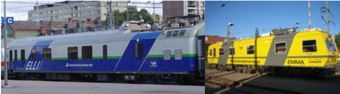
KUVA 7. Radantarkastusvaunut ELLI ja EMMA (Radantarkastuspalvelut. 2010)
