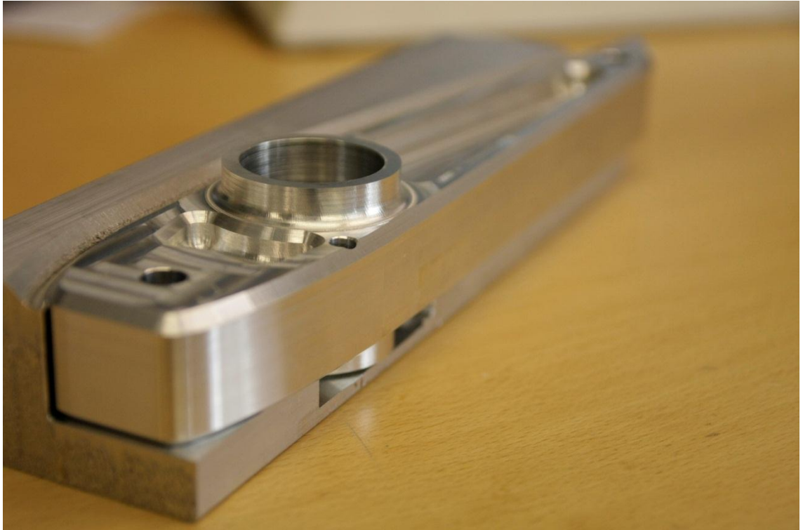
Kuva 13. CNC-koneistetut hydraulipoljin ja polkimen jigi.
