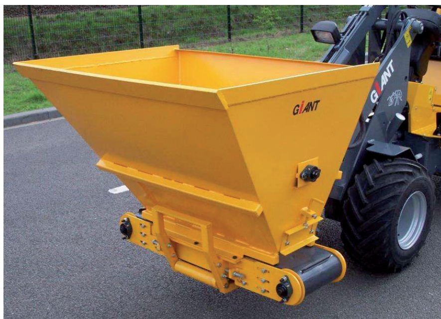
Kuvio 4.5. Pienkuormaajan etukauhaan kiinnitettävä jakokauhan tilavuus on 600 l. Kauhalla voi jakaa molemmille puolille kuiviketta.
