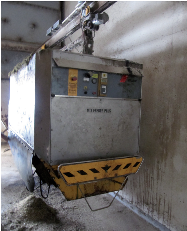
Kuvio 4.3. Aperobotti tekee, sekoittaa ja jakaa seoksen jokaiselle eläinryhmälle automaattisesti ohjelmoitujen reseptien mukaan.
