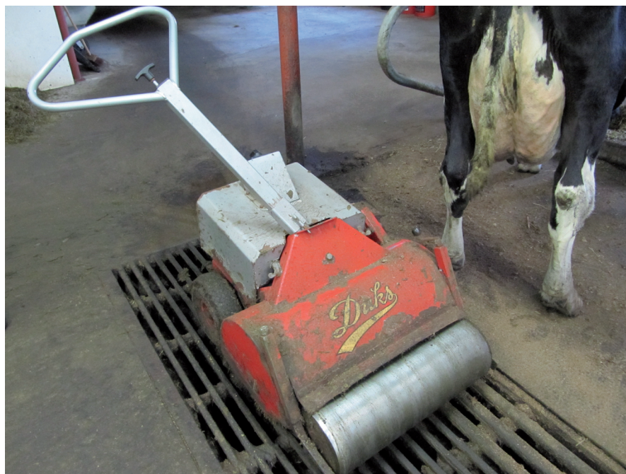
Kuvio 4.2. Lantaritilöiden puhdistukseen käytetään akkukäyttöistä harjakonetta.
