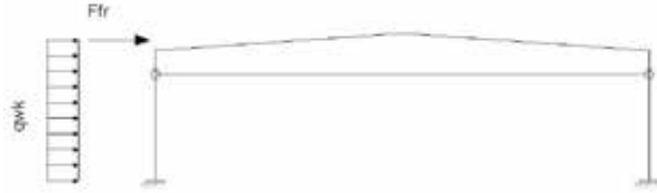
Kuva Mastojäykistetty teräsbetonihalli
