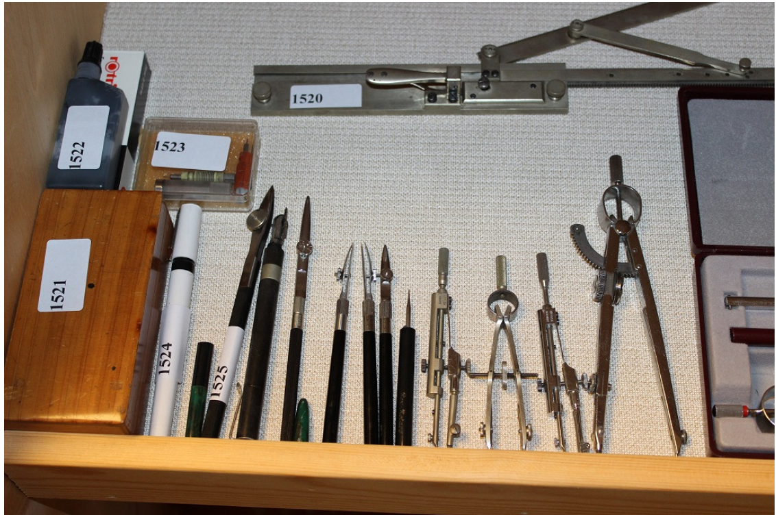
Kuva 7. Harpit ja tussipiirtimet olivat piirtäjien ja suunnittelijoiden apuvälineitä ennen CAD-suunnittelua. (Tekijän kuva)
