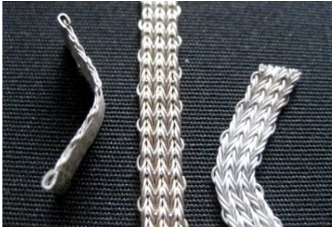
KUVA 7 Hopeanauhan taipuminen loimensuuntaisesti ja kuteensuuntaisesti suhteessa suoraan nauhaan. – Valok. Marjo Maula.
