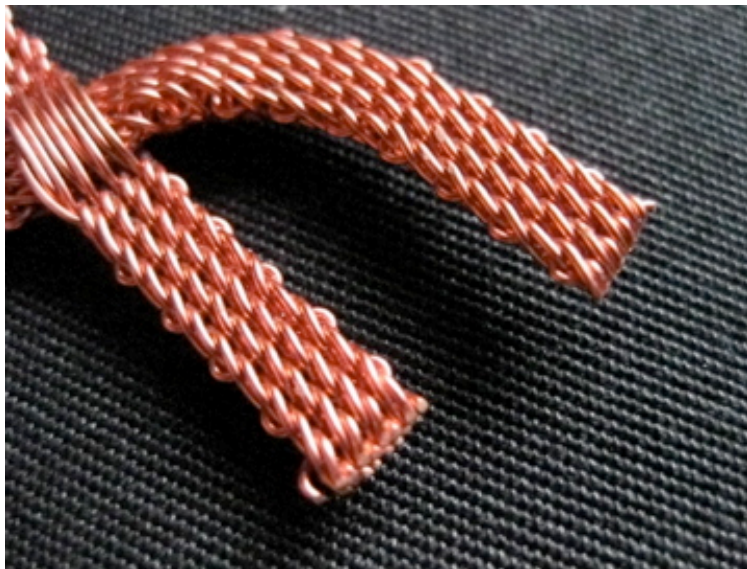
KUVA 5 Leikkuukohdan merkitys metallinauhan purkautumattomuuteen. – Valok. Marjo Maula.
