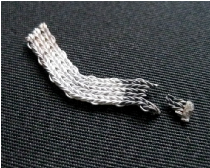
KUVA 8 Liian kovan kohdelämmön takia sulanut hopeanauha. – Valok. Marjo Maula.
