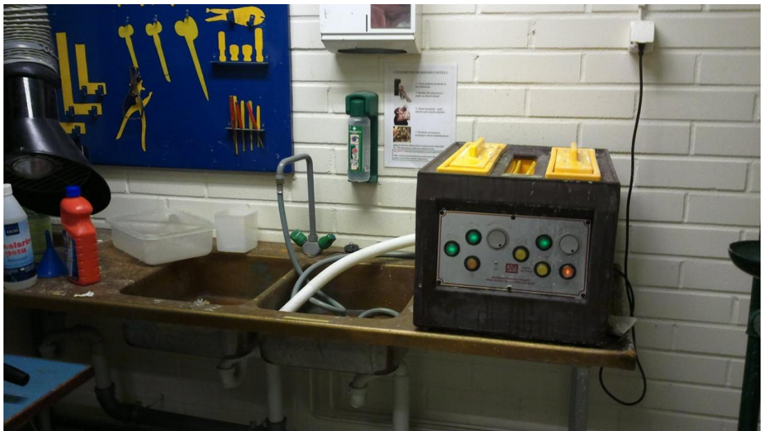
Kuva 5. Kotekon kampuksen piirilevyjen syövytysallas
