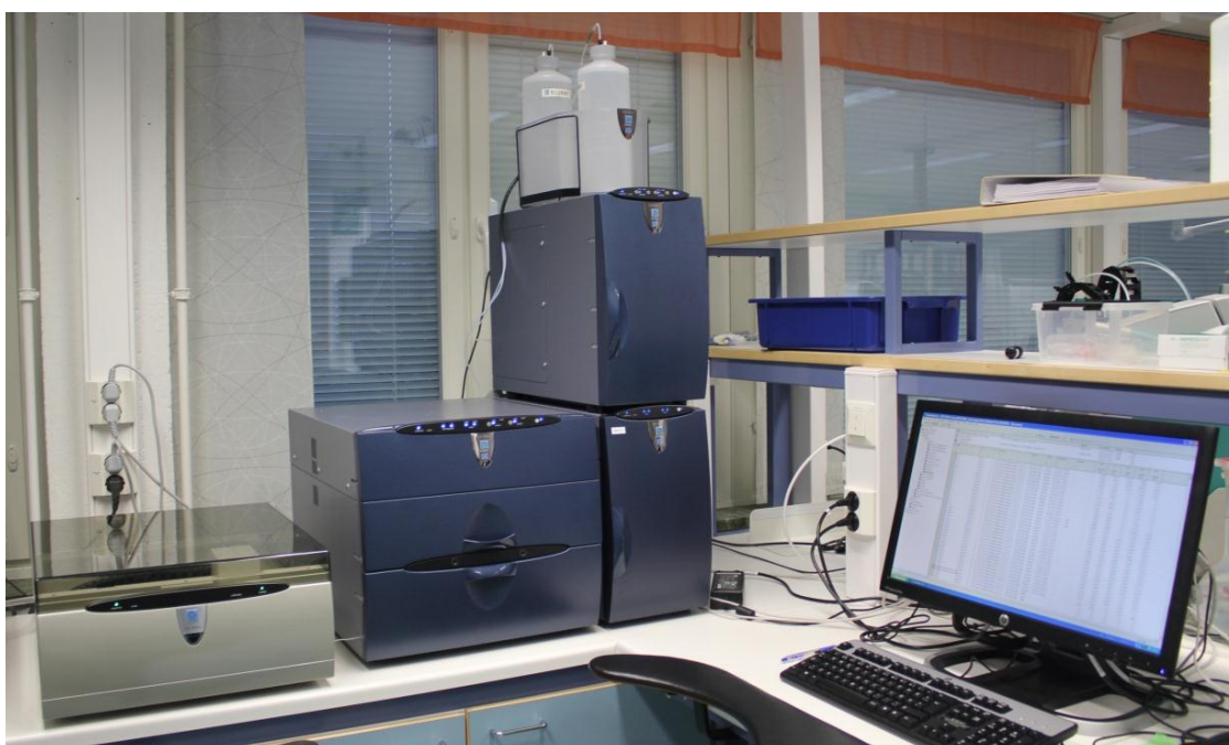
KUVA 2. AS-DV -autosampler (vas.), Dionex ICS-5000 -laitteisto sekä PC-tietokone
