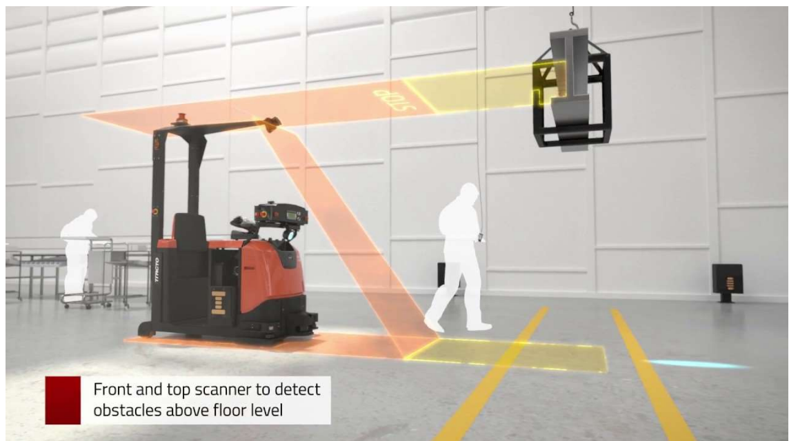
Kuva 7. AGV-ajoneuvon turvalaserit ylä- ja alaosassa. [12.]
