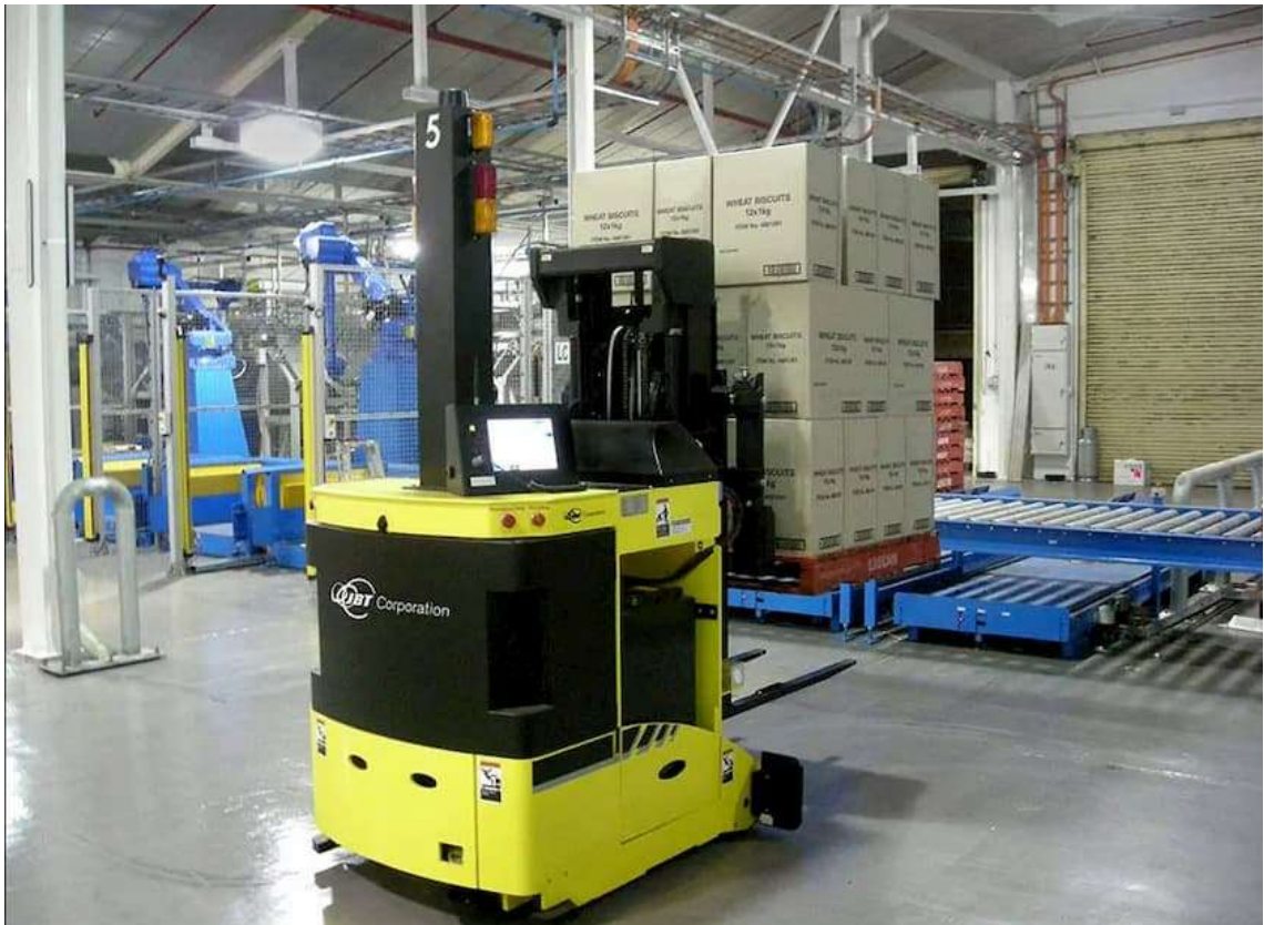
Kuva 1. Erään valmistajan AGV nostamassa lavaa liukuhihnalle. [2.]
