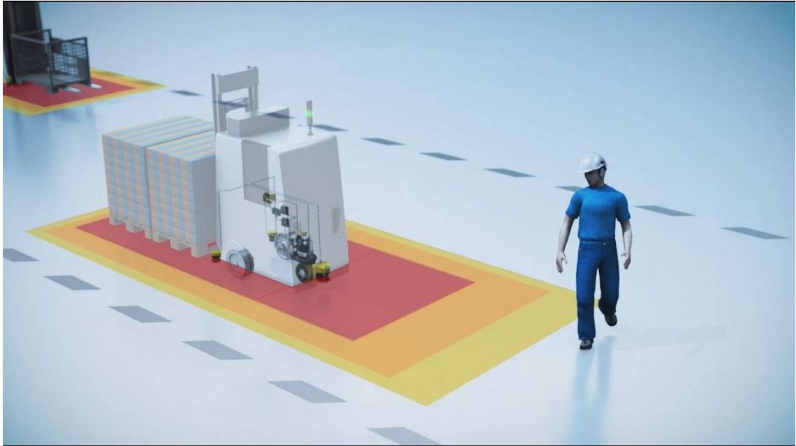
Kuva 6. AGV-ajoneuvon laserskannerin turvaetäisyys. [11.]
