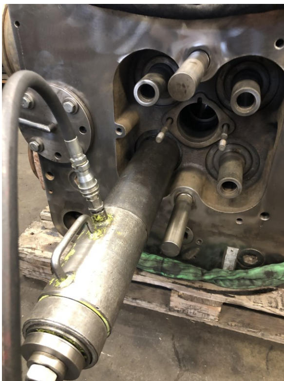
Kuva 19. Venttiiliohjaimen irrotus hydraulipuristimella
