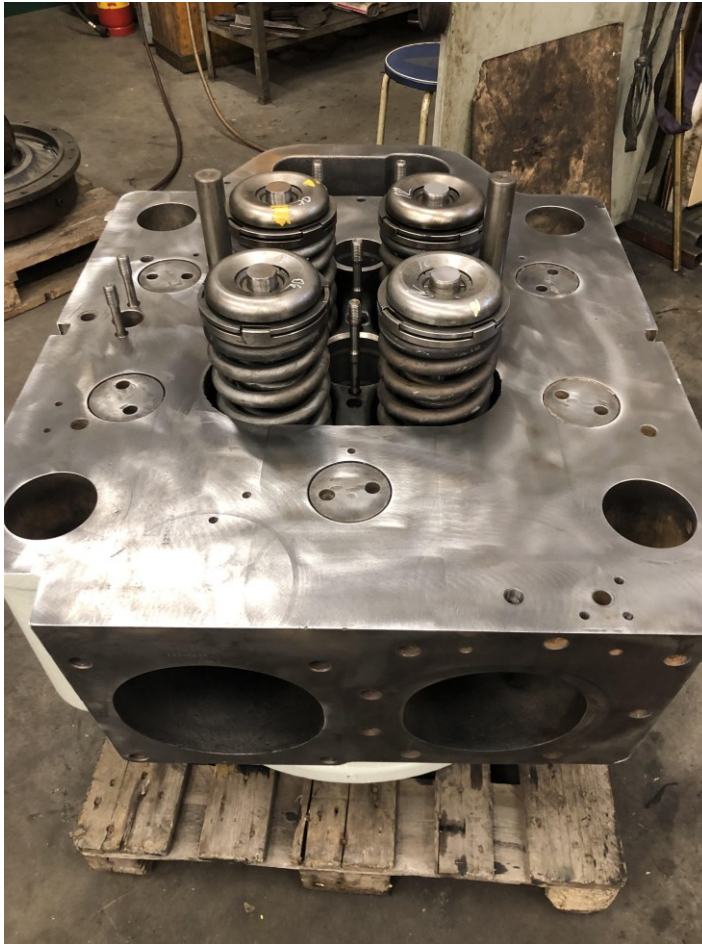
Kuva 21. Huollosta valmistunut sylinterinkansi
