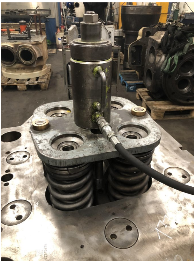
Kuva 20. Hydraulipuristin venttiilinjousten päällä
