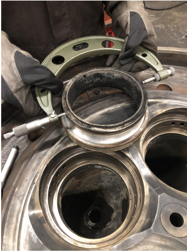
Kuva 11. Seetirenkaan mittaus kaarimikrometrillä
