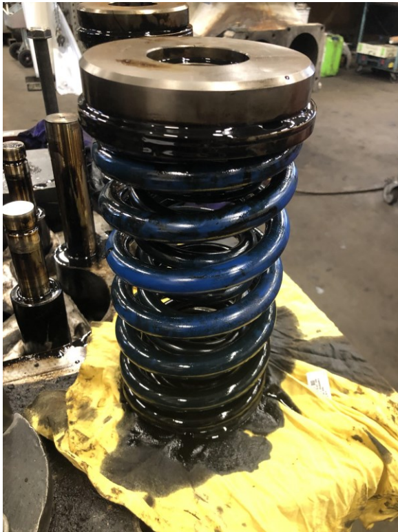
Kuva 4. Irrotettu venttiilinjousi, jonka päällä rotocap
