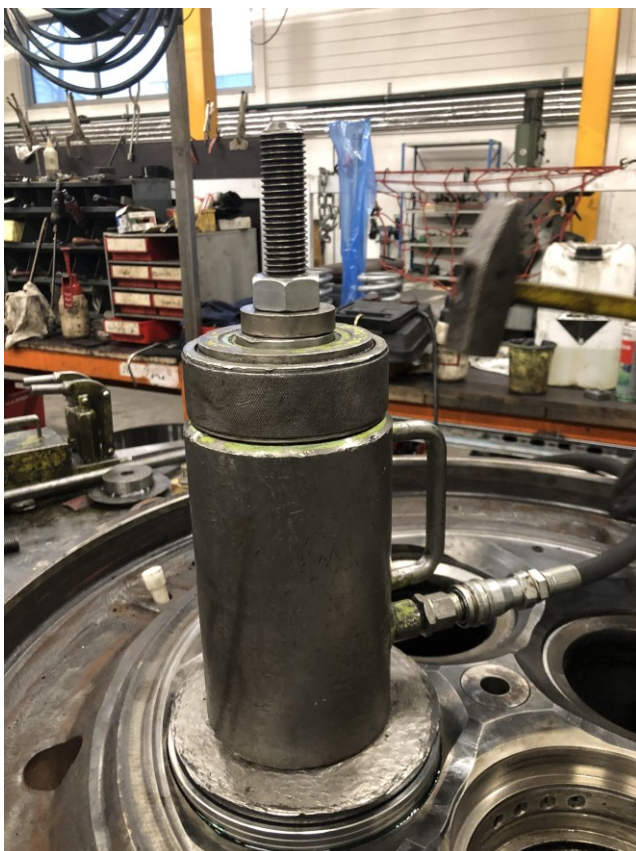
Kuva 14. Seetirenkaan asennus hydraulipuristimella
