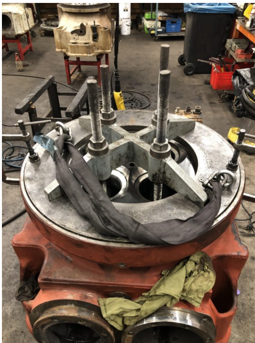
Kuva 8. Koeponnistusrauta kiinnitettyä sylinterinkanteen
