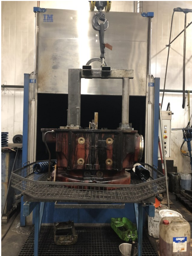
Kuva 5. Sylinterinkansi ja komponentit menossa pesuun
