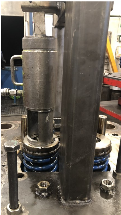
Kuva 3. Hydraulipuristin asennettu venttiilinjousen päälle
