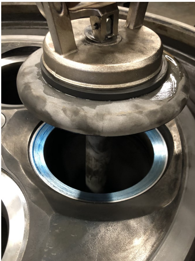
Kuva 18. Väriaine levittyneenä seetirenkaan pinnalle
