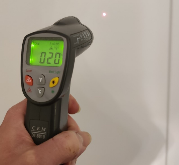
Kuva 21. Infrapunalämpömittarilla lämpötilan mittaaminen seinäpinnasta.
