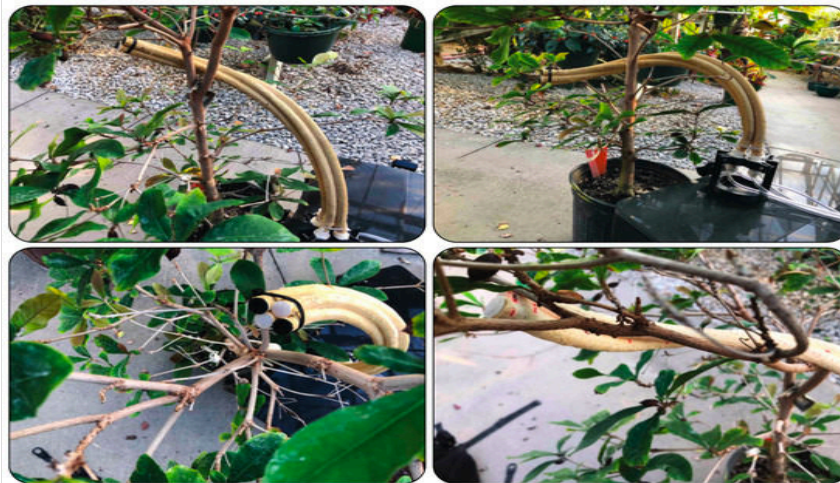
Kuvio 8. Agbot -robotti. Alustavat tutkimustyöt osoittavat, että pieniin Agboteihin asennetut pehmeät tarttujat ovat skaalautuvia, edullisia ja tehokkaita.
