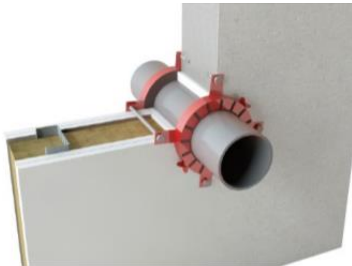
Kuva 4. Muovinen putkiläpiviennissä käytetty mansettiä, joka turpoaa palotilanteessa.
