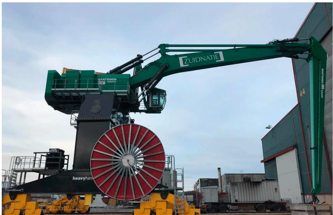
Kuva 2. Kuvassa sähkökäyttöinen materiaalinkäsittelykone [1].
