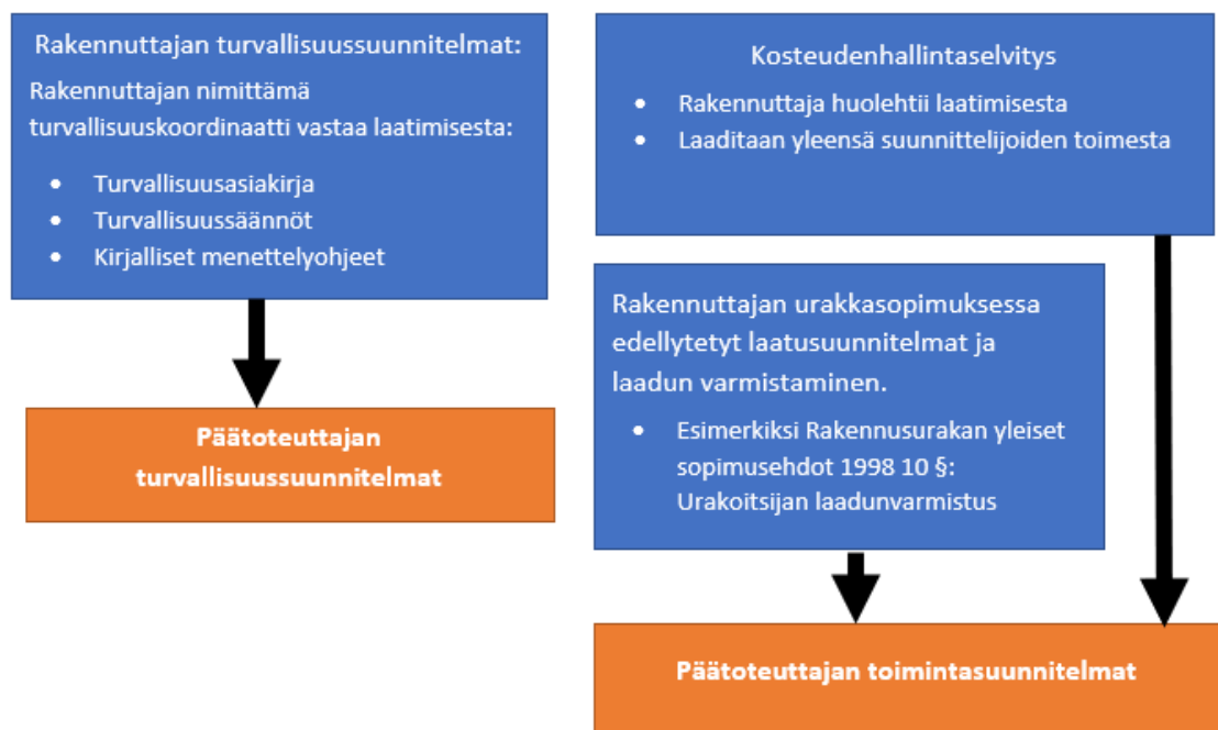
Kuva 4. Rakennuttajalta tulevia lähtötietoja päätoteuttajan suunnitelmiin.
