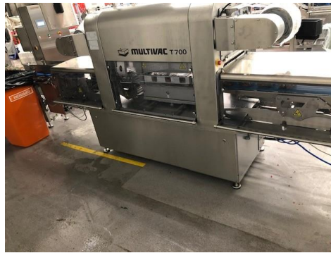
Kuva 14. Multivac T700 – rasiapakkaukone, johon on liitettyä MAP-pakkaamista varten kaasuliitännät hapelle, typelle sekä hiilidioksidille.
