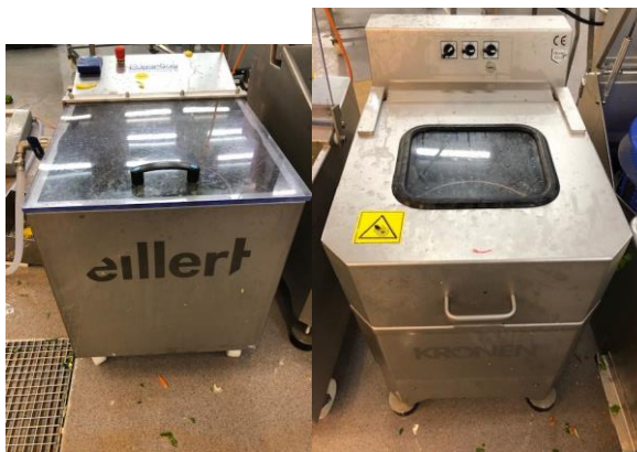
Kuva 13. Vasemmalla kuvassa Eillert GWB-1000 – eräpesuri, jolla voidaan pestä tuoreleikattuja kasviksia ja oikealla kuvassa on Kronen Spin-dryer KS-600 – rumpulinko, jolla voidaan kuivata pesemisen jälkeen tuoreleikattuja kasviksia.
