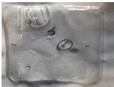
Kuva 21. Perforoitu kalvo, jossa merkittynä perforointireiät ympyröitynä mustalla tussilla. Kalvo on otettu näytteestä: Ensimmäinen osio, kukkakaali, 1 + 7 päivän säilyvyydellä, näytteestä 1, 3. rinnakkaisnäyte.
