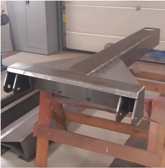
Figur 12. Bom delen svetsades ihop med MIG/MAG-svetsning.
