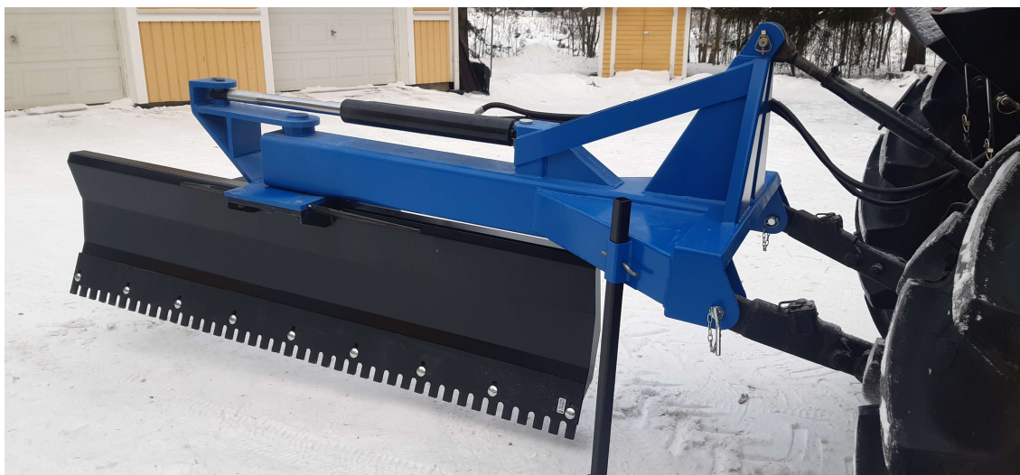
Figur 17. Schaktbladet vinklat för transport.
