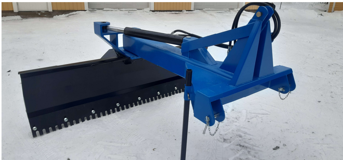
Figur 16. Det färdiga schaktbladet.
