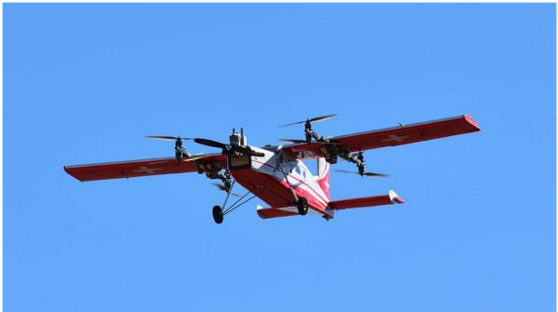
Kuvio 8. QuadPlane kahdeksalla pystyasennossa olevalla roottorilla (ArduPlane – QuadPlane overview n.d.)
