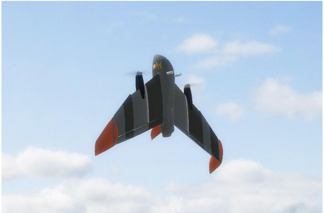
Kuvio 9. Kaksimoottorinen tailsitter-kone leijuntatilassa
