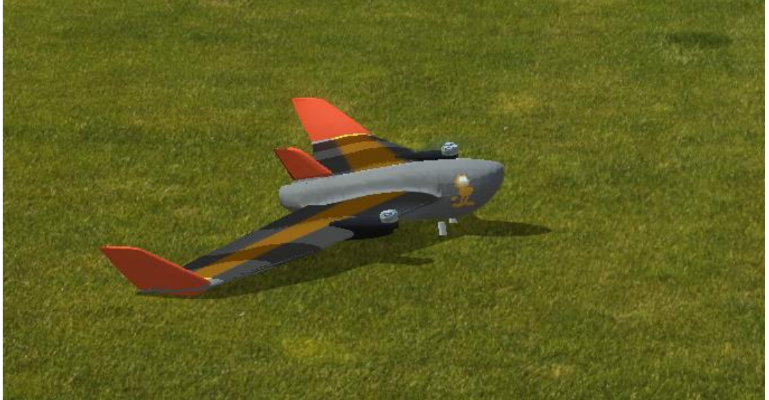
Kuvio 10. Tailsitter-kone kääntyvillä moottoreilla lähdössä lentoon mahaltaan
