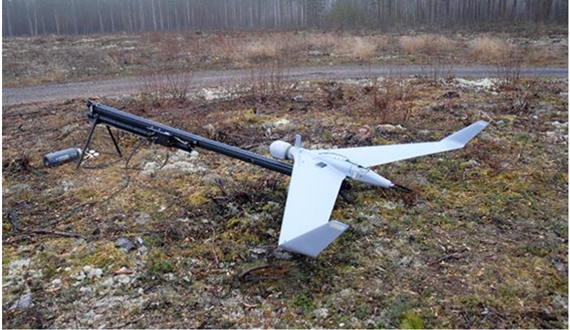
Kuvio 7. Suomen maavoimien Orbiter 2b tiedustelulennokki katapultissaan (Minilennokkijärjestelmä n.d.)
