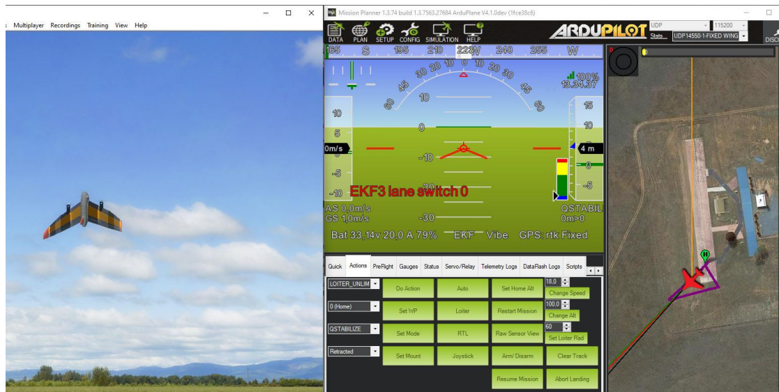
Kuvio 14. Tailsitter-koneen simulointi RealFlight 8:aa ja Mission Planneria käyttäen
