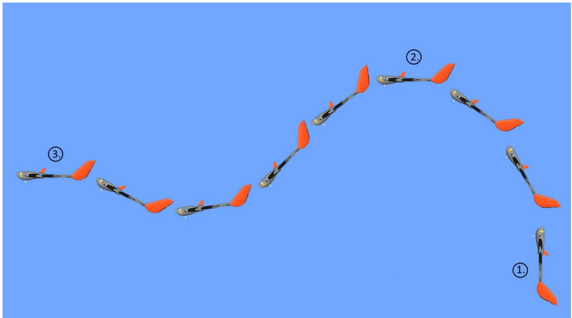
Kuvio 3. Tailsitter-koneen siirtymä VTOL-tilasta normaaliin lentotilaan
