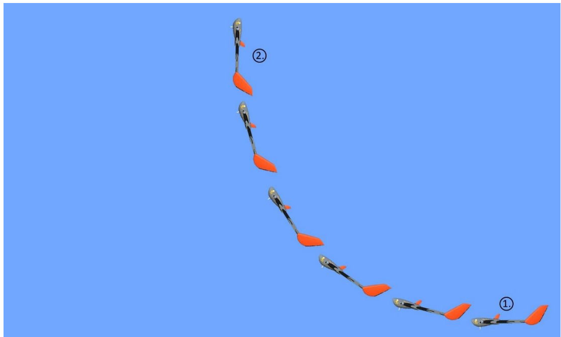
Kuvio 2. Tailsitter-koneen siirtymä normaalista lentotilasta VTOL-tilaan
