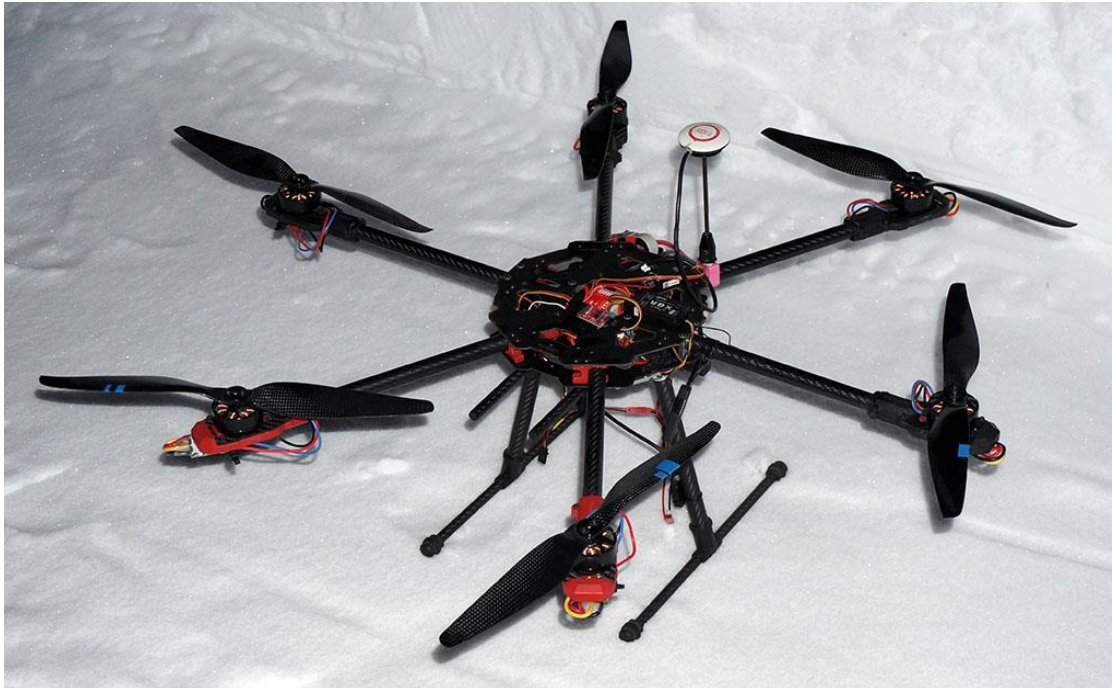
Kuvio 4. Kuusiroottorinen multikopteri eli heksakopteri
