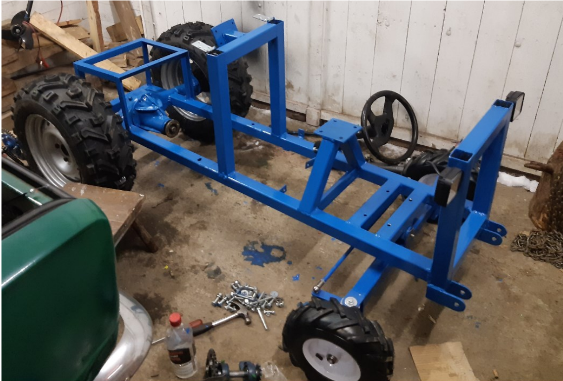
KUVA 39. Runko ja etuakseli maalattuna
