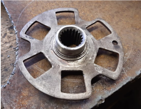
KUVA 31. Kytkinlevyn booriosion irrotus työn alla, osasta poistetaan vielä laippa, jättäen vain putkimainen osuus
