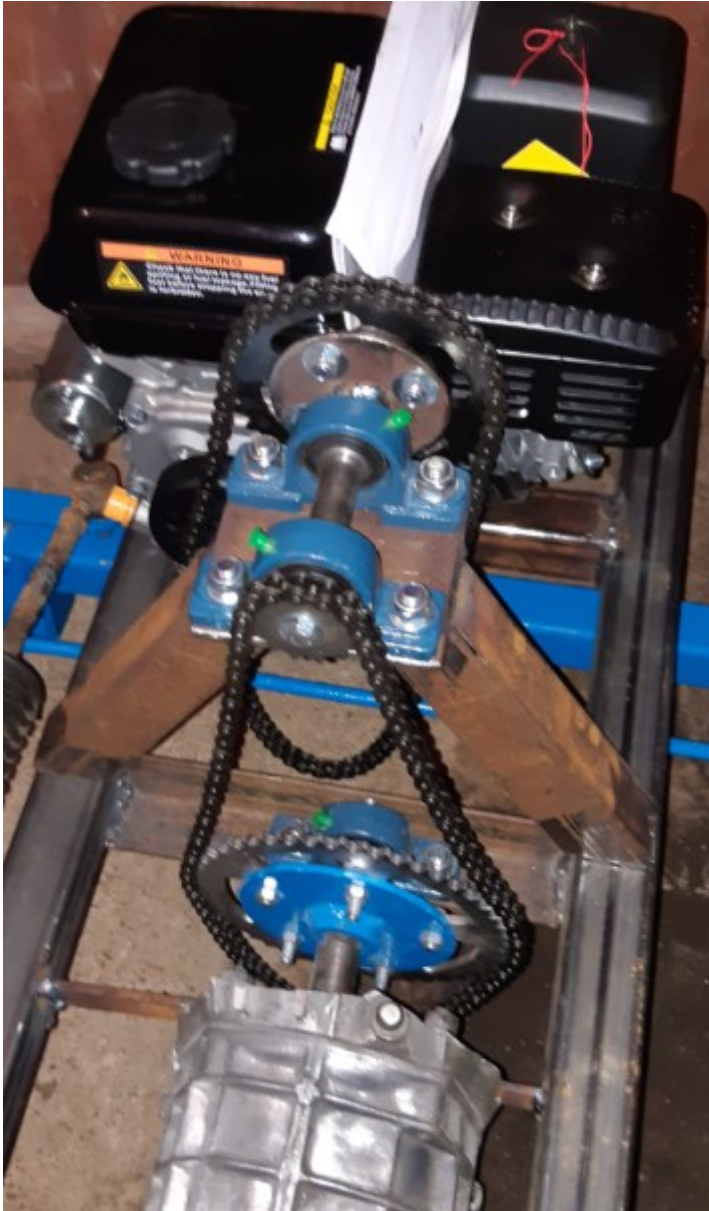
KUVA 38. Moottori ja ensiövälyitys asennettuna
