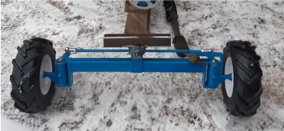
KUVA 27. Etuakseli maalattuna ja koottuna
