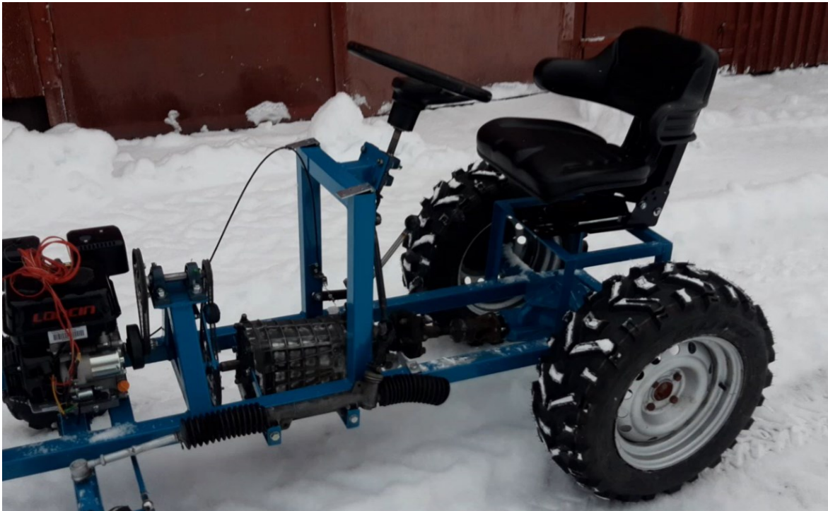
KUVA 40. Ohjaus ja istuin asennettuna
