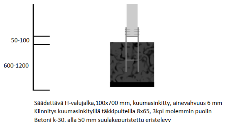
Kuva 6. Betoniperustus, H-jalka (Kruunuaita, 2013).
