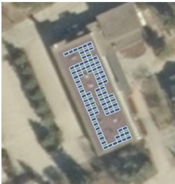
Kuva 8. Tuotantosimulaation mukaan paneelien tilantarve ja sijoittelu 28,8 kWp:n järjestelmälle, 80 paneelia (Ruuhonen S. 2021).
