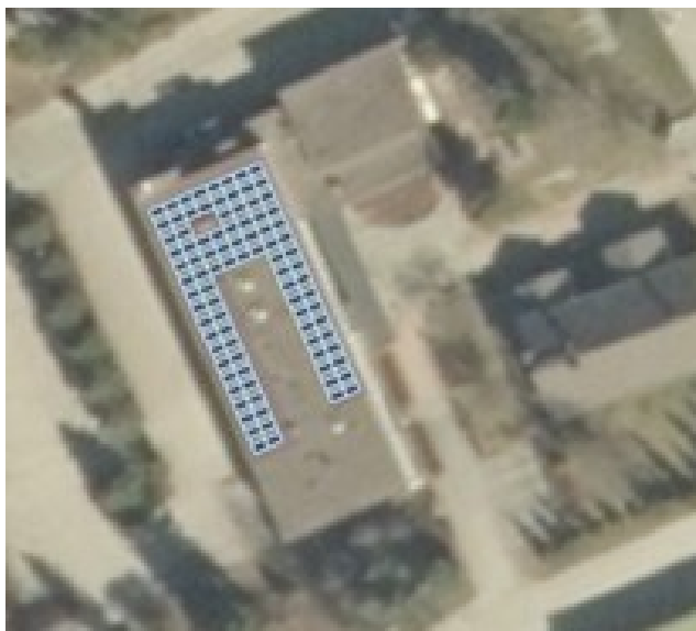
Kuva 9. Tuotantosimulaation mukaan paneelien tilantarve ja sijoittelu 25,3 kWp:n järjestelmälle, 92 paneelia (GEF Planter 2019).
