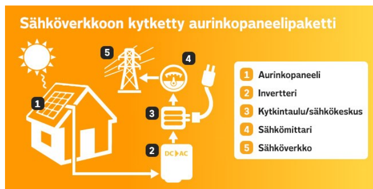
Kuva 2. Sähköverkkoon kytketyn aurinkojärjestelmän toimintaperiaate (Vattenfall 2020).
