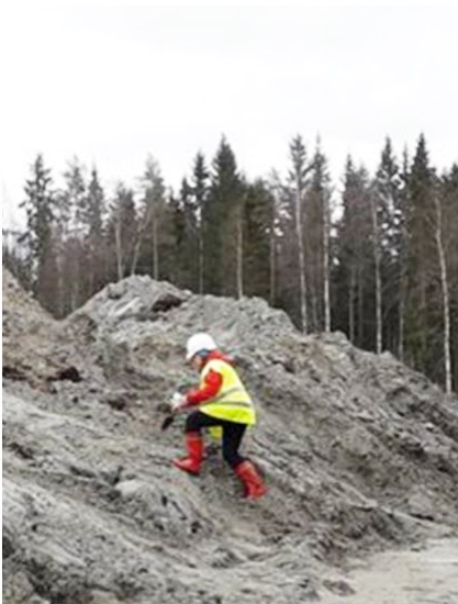
KUVAT 5-7. Vasemmalla näytteiden ottoa ylijäämämaasta 8.5.2019 Oulun Korvenkylässä (kuva: Laura Sihvonen), keskellä maamassan levitystä Välilimaalla (kuva: Venla Honkala) ja oikealla maamassojen levitystä kaivinkoneella. Vesisateiden vuoksi maa-aines oli hyvin upottavaa (kuva: Laura Sihvonen)
