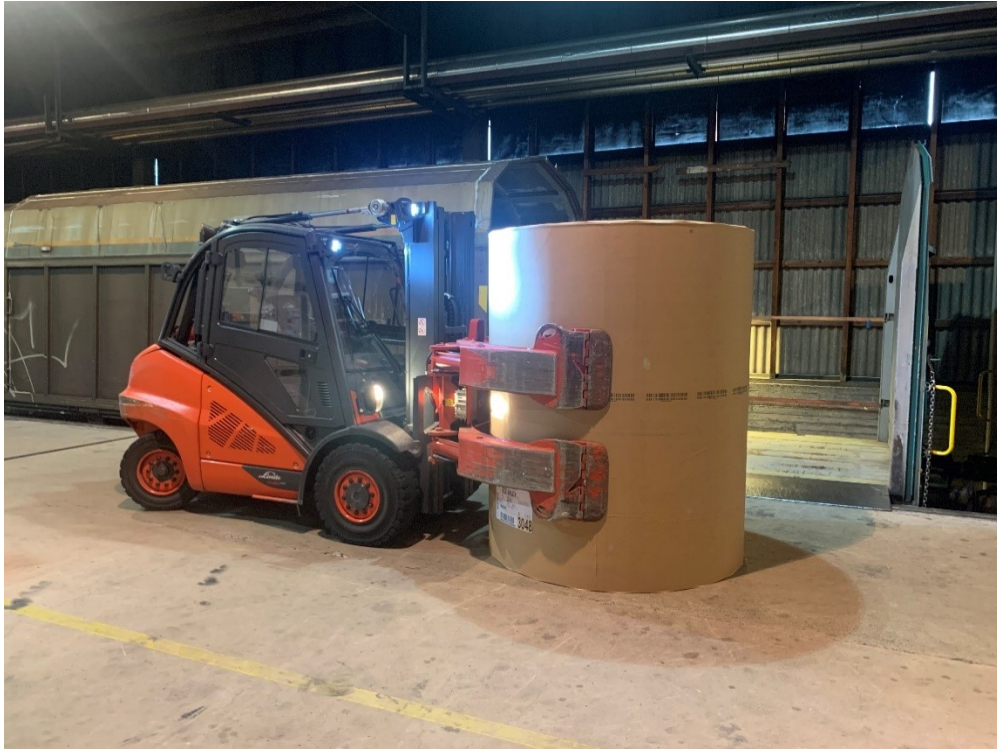
Kuva 8. Linde-trukki varustettuna rullapihdein
