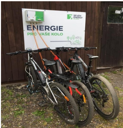
Kuva 17. Powerbox.one sähköpyörien latausasema (27).
