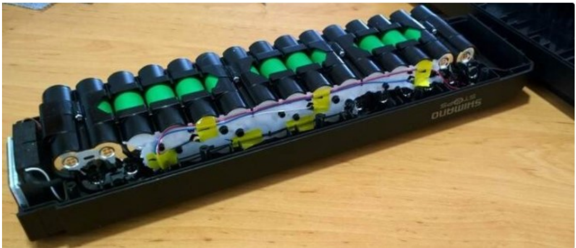
Kuva 7. Shimano STEPS BT-E600-akku, jossa on 40 kpl Sony US18650NC1-akkuja (17).
