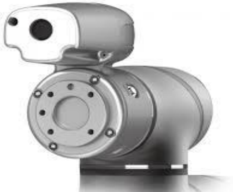
Kuva 2. Konenäkökamera robotin käsivarressa [10].
