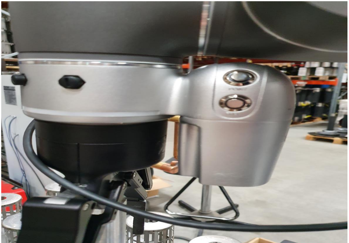
Kuva 8. Robotin kameran sivussa paikan tallennus- ja liikennapit.
