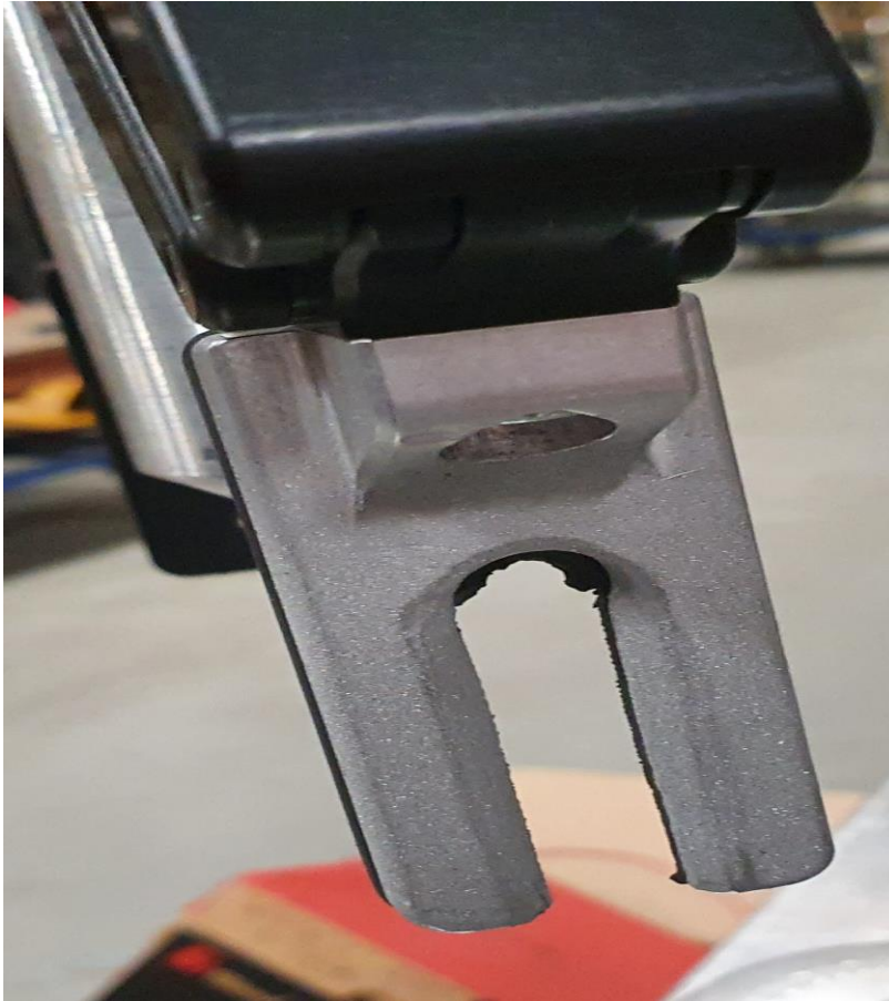
Kuva 15. Tarttujaan tehty lovi hitsausta varten.
