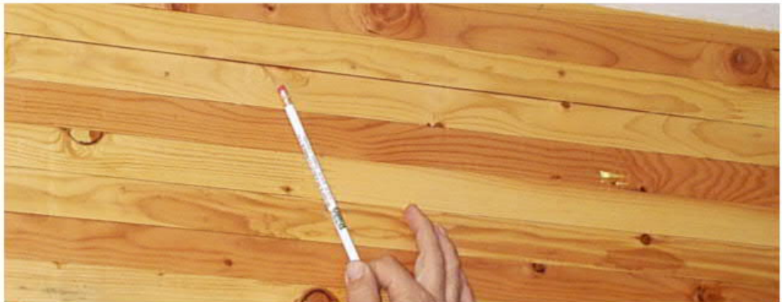
Kuva 9. Liimapuupalkin liimavirhe (Boise cascade, tech note BG-1)
