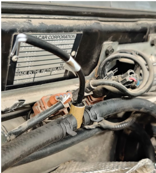
Kuva 13. Lämpötila-anturi liitettynä nestekierron tuloletkuun.
