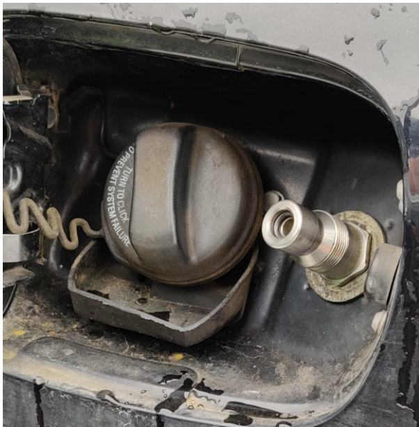
Kuva 21. Tankkausliitin asennettuna polttoaineluukun alle. Liittimen päälle tulee kuminen suojatulppa.
