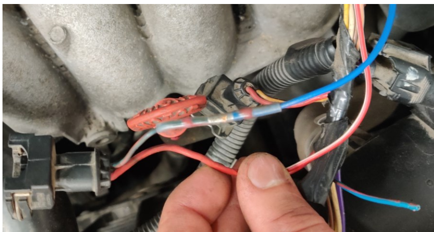
Kuva 22. Kaasujärjestelmän suutinohitusjohdon kytkentä bensiinisuuttimen liittimen taakse eristetyllä tinajatkoliittimellä.
