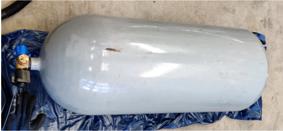
Kuva 4. CNG-1 -luokan metallisäiliö, jossa kiinni säiliöventtiili. Säiliön vesitilavuus on 76 litraa ja siihen mahtuu noin 12 kg kaasua.
