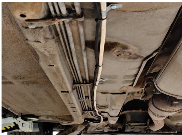
Kuva 20. Korkeapaineputki säiliöltä paineventtiilille kiinnitettynä auton alustaan. Kaasuputkeen kiinnitettynä säiliöventtiilin solenoidin sähkökaapeli.
