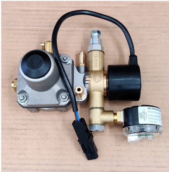
Kuva 3. Landi Renzo NG1 -paineensäädin, jossa solenoidiventtiili ja painemittari optisella anturilla.
