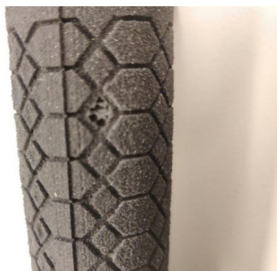
Figur 39 Defekt för att den fastnat.
