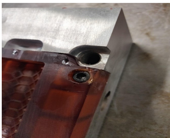
Figur 33 sprickor vid kanter av formhalvan.
