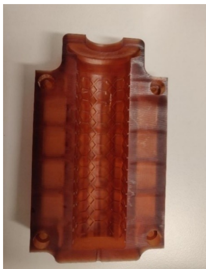
Figur 29 Formhalva efter UV-härdning.
