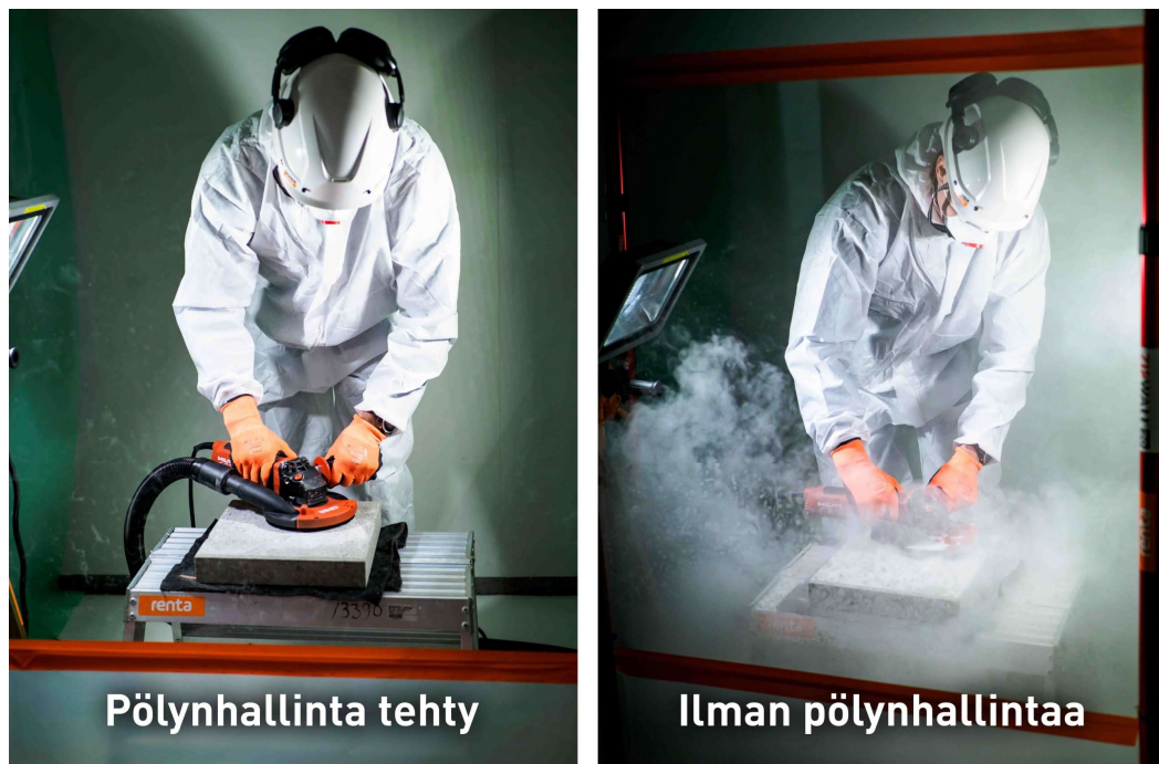
Kuva 2. Renta Oy:n kuva kohdepoiston vaikutuksesta pölyn leviämisen estämisessä
