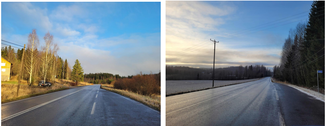
Kuva 10. Vasemmanpuoleisessa kuvassa on tienpinnalle aamulla (17.12.2020) levitetty Natriumkloridia ja oikeanpuoleisessa kuvassa kierrätysuolaliuosta.
