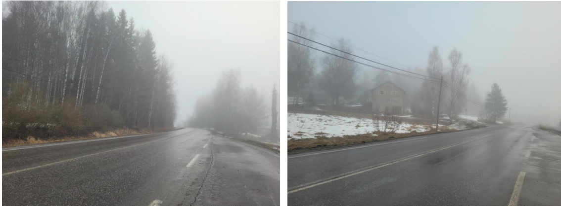
Kuva 14. Vasemmanpuoleisessa kuvassa liukkaudentorjunnassa on käytetty kierrätysuoliuosta ja oikeassa kuvassa natriumkloridia
