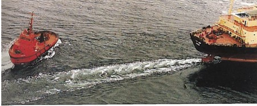
Kuva 9. Void Schneider -hinaaja suorittamassa leikkausta aluksen perässä. (Hensen 2003)
