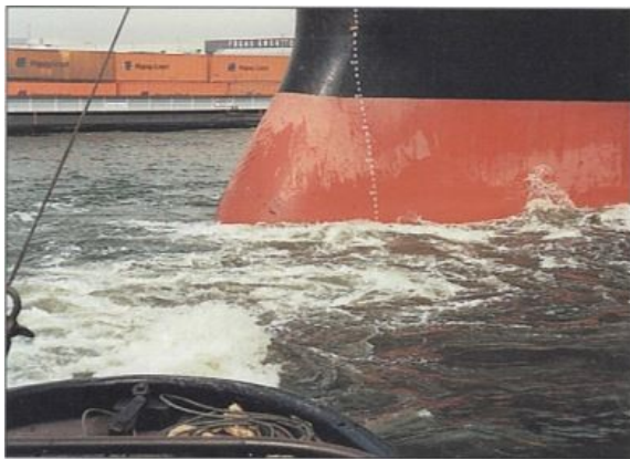
Kuva 11. Potkurivirran osuminen aluksen keulaan havainnekuva. (Hensen 2003)
