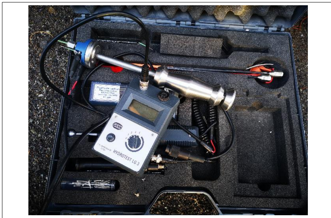
Kuva 9. Kuvassa on GANN Hydrotest LG3 kosteusmittari + junta eristetyillä puupiikeillä. Opinnäytetyön kohteena olleen rakennuksen puun kosteuden mittaukset tehtiin kyseisellä laitteella. (Minkkinen 2020)
