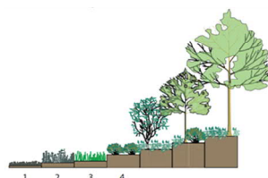
Kuva 6. Viherkattotyypin 1-4 kasvualustapaksuudet: 1. maksaruohokatto 60...80 mm 2. niittyketokatto 150...200 mm 3. heinäkatto 200...300 mm 4. kattopuutarha 200...1000 mm kasvialueitaisten vaatimusten mukaan
