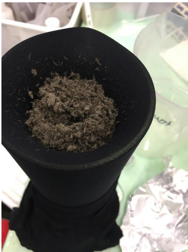
KUVA 15. Nesteensitomiskykyä testatessa kuitusavea laitettiin sukkahousujen sisään liotusta varten (Tikkanen 2020-10-22).
