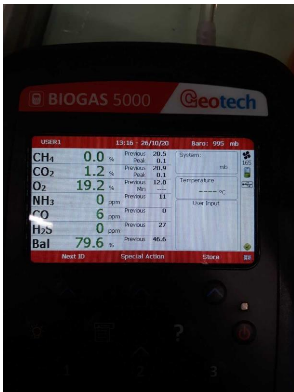
KUVA 21. Ammoniakin (NH 3 ) pitoisuus pelkkää virtsaa sisältävässä pullossa oli vielä 96 tunnin kuluttua kokeen aloituksesta edelleen nolla (Tikkanen 2020-10-22).
