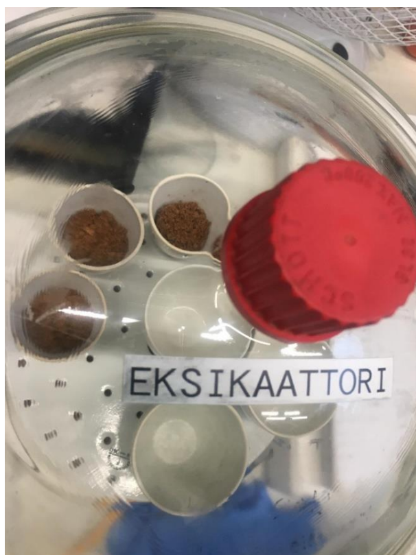
KUVA 11. Eksikaattorin pohjalla oleva kuivausmassa pitää kuvun sisäisen ilmankosteuden stabiilina (Tikkanen 2020-10-22).
