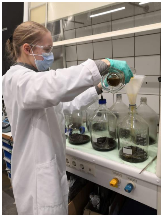
KUVA 13. Ammoniakinsitomiskykyä testatessa lasipulloihin laitettiin 500 millilitraa kuitusavea ja 100-400 millilitraa edellisenä päivänä kerättyä lehmän virtsaa (Antikainen 2020-10-22).
