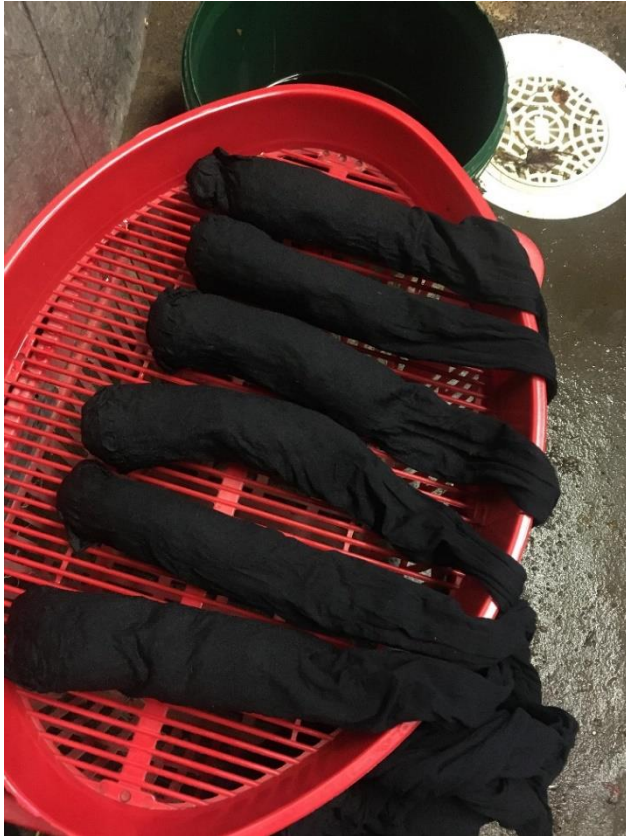
KUVA 16. Näytteitä liotettiin virtsassa, riiputettiin ilmassa ja asetettiin ritilän päälle valumaan, minkä jälkeen näytteet punnittiin ennen uutta liotusta (Tikkanen 2020-10-23).
