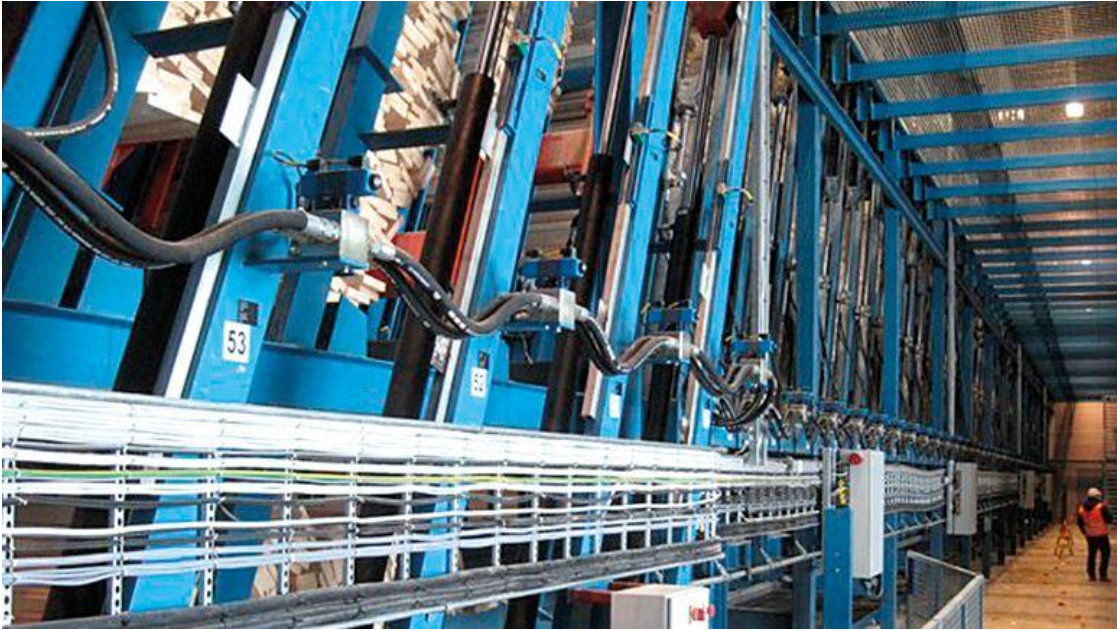
Kuva 3. Dimensiolajittelulaitoksen vinolokerosto (Heinolan sahakoneet Oy 2021)
