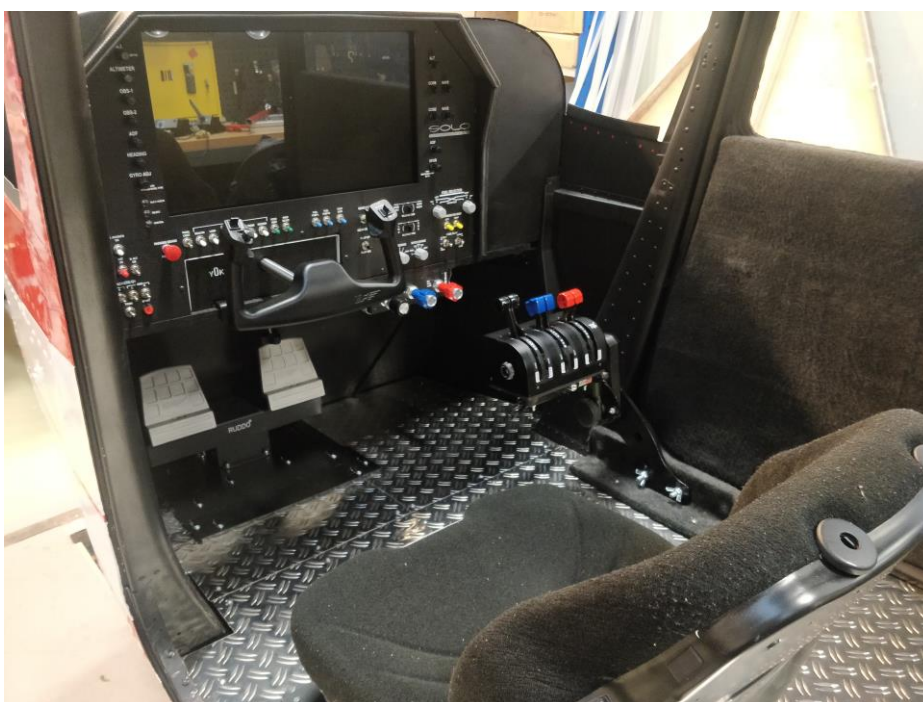
KUVA 20. Toissijainen kaasuvipuohjain asennettuna
